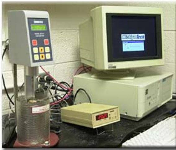
Resim 5.2 Viskozite tespiti için kullanılan viskozimetre
