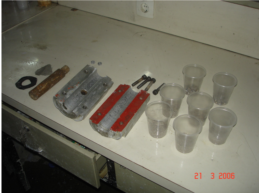
Resim 5.4. Serbest basınç deneyi numunesi moldu
