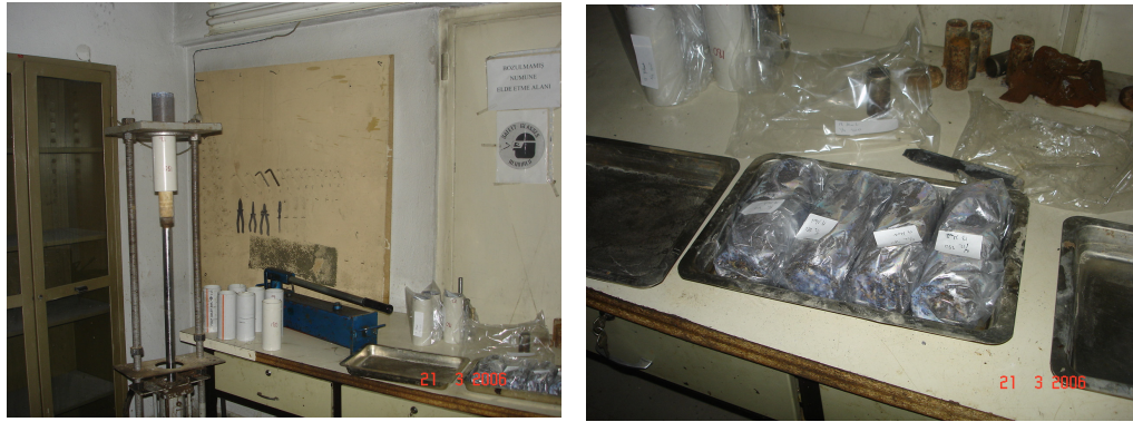
Resim 5.9. Numunelerin moldlardan çıkarılması ve deney için hazırlama
