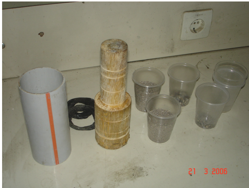
Resim 5.8. Devinimli üç eksenli deneyi moldu ve tokmak
