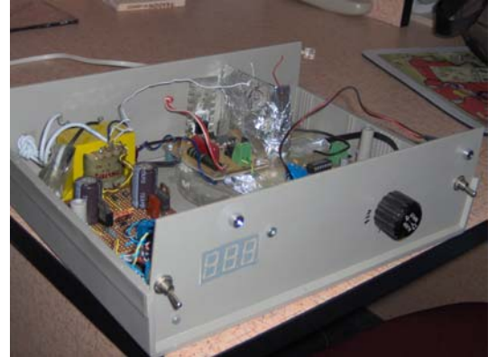
Şekil 3.7. Kimyasal püskürtme sistemlerinde kullanılmak üzere tasarlanan sıcaklık kontrolcüsü.
