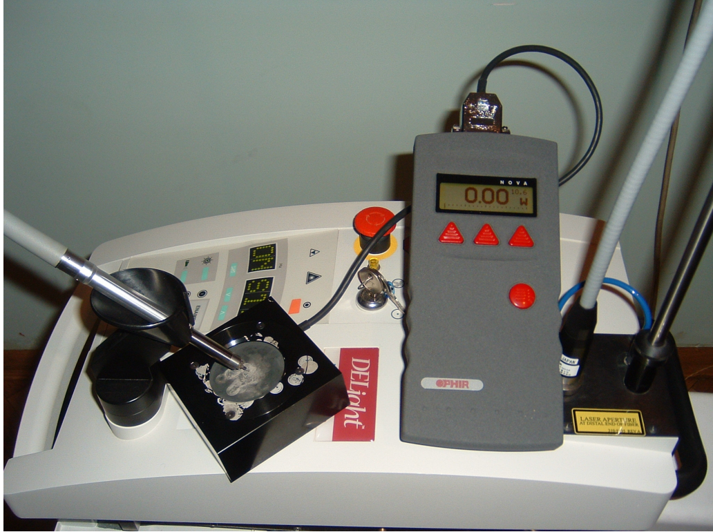
Şekil 4.22 VersaWave Er:YAG 2940 Model Laser Cihazının Ophir Nova L40(150)A Power Detektor Sistemi ile Kalibre Edilişi
