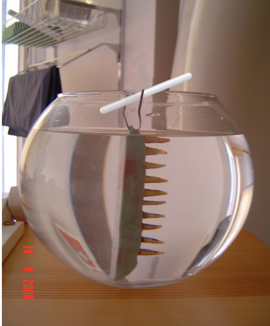
Şekil 4.16 Glob İçinde Oluşturulan Su Ortamındaki Master Elemanla Dişler
