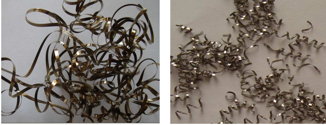
Resim 7.11. (a) a=1 mm f=0,10 , V=75 m/min talaş kırıcısız, (b) a=1 mm f=0,10 , V=75 m/min talaş kırıcılı.
