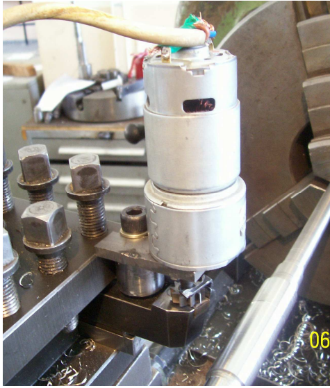
Resim 7.4. Redüktörlü doğru akım motoru ile talaş kırıcı tasarımı
