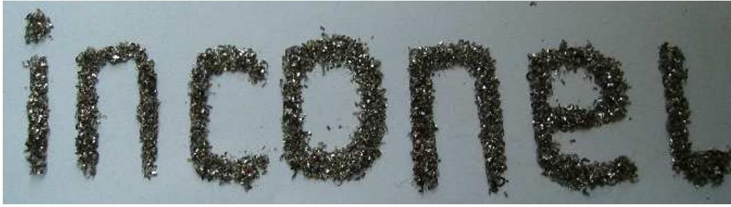
Resim 7.17. V=75 m/min f=0,10 mm/rev ve talaş derinliği 0,5 mm de yapılan işlemede elde edilen talaş
