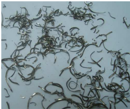
Resim 7.5. 350 rev/min devirli DC motorla yapılan işlemede oluşan talaş şekli
