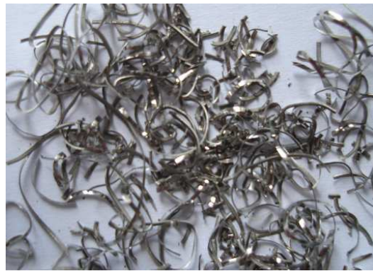
Resim 7.5. 350 rev/min devirli DC motorla yapılan işlemede oluşan talaş şekli
