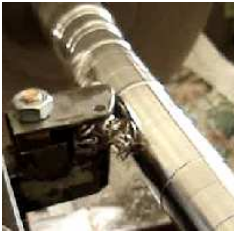
Resim 7.2. 0.5 mm ve 1 mm talaş derinliği ve 0,10 mm/rev de talaşın davranışı
