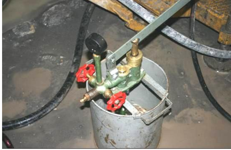
Şekil 3.24. Pakerin su ile şişirilmesini sağlayan pompa
