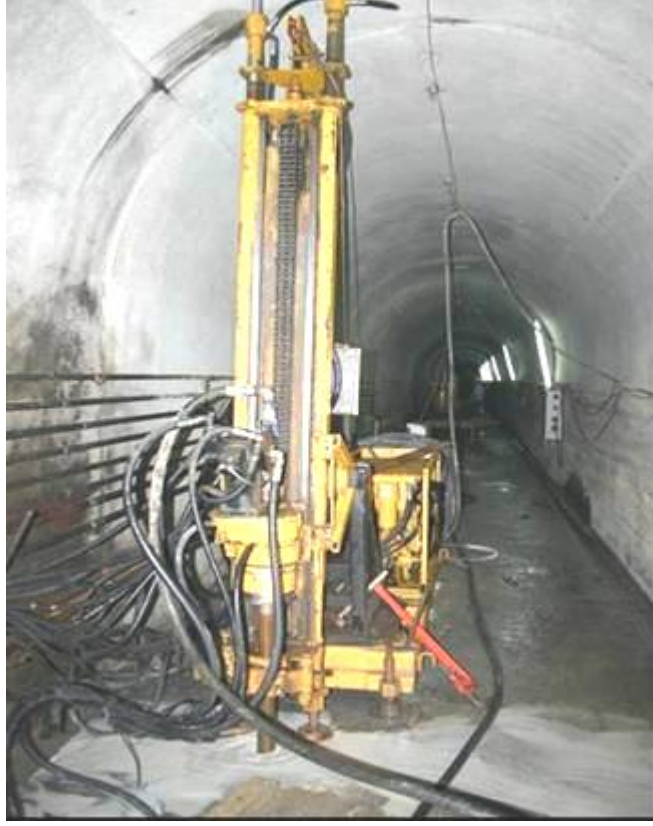
Şekil 3.9. Diamec-260 delgi esnasında
