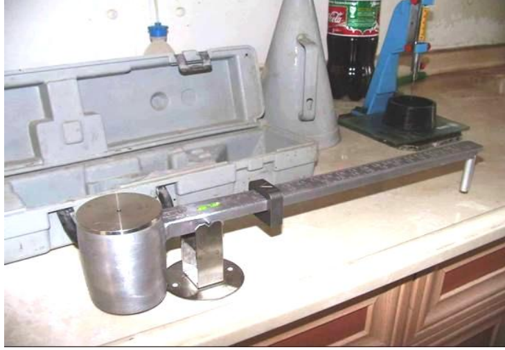
Şekil 3.23. Enjeksiyon karışımının özgül ağırlığını gösteren çamur terazisi
