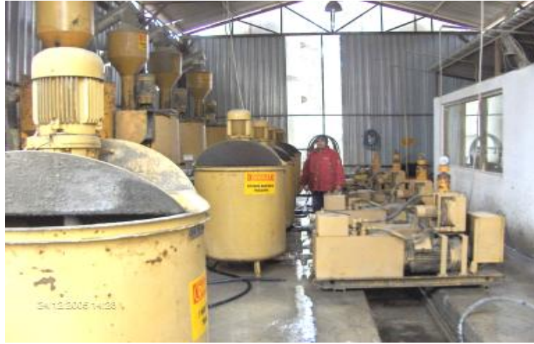
Şekil 3.15. Sağ sahil ana enjeksiyon merkezi ana elemanları
