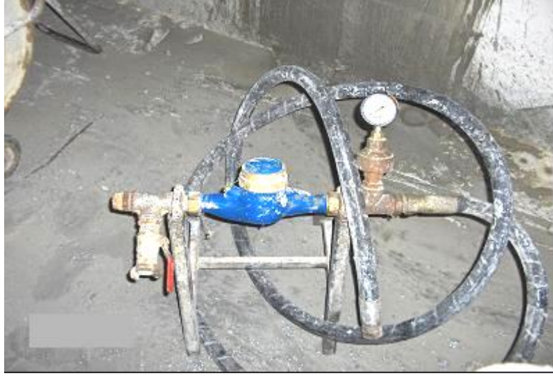
Şekil 3.20. Esas kullanım amacı basınçlı su testi olan su saati
