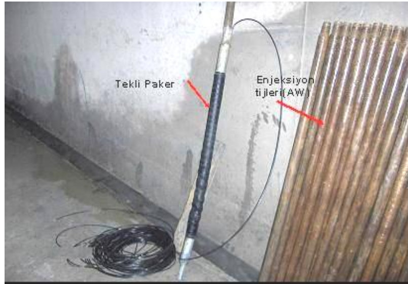
Şekil 3.17. Tekli pnömomatik paker (1 metre) ve Enjeksiyon tiji (AW)
