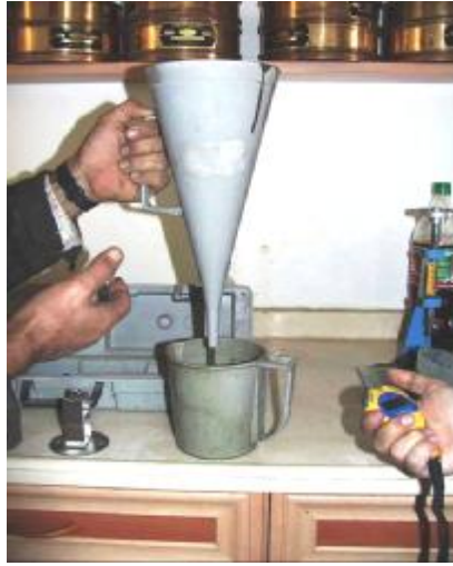
Şekil 3.22. Viskozite ölçmeye yarayan marsh hunisi
