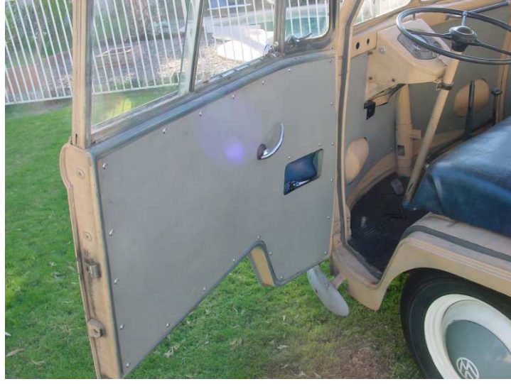
Resim 4.82. Araç kapısında suntalam uygulaması (169)
