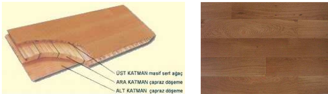
Resim 4.3. ve 4.4. Lamine parke tabakaları (solda) (190), lamine parke görünüşü (sağda)
