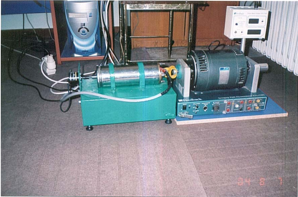
Şekil 2 Anahtarlı relüktans motor ve DA şönt generatör yakın çekim fotoğrafı.
