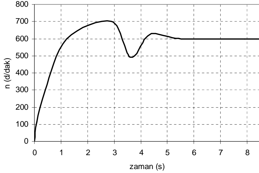
Şekil 5.66 ARM sürücünün n=600 d/dak referans hız V=34 V besleme geriliminde yüklü durumda kapalı çevrim hız ve akım kontrolünde ölçülen hızın değişim grafiği ( T_y=0.46 Nm).
