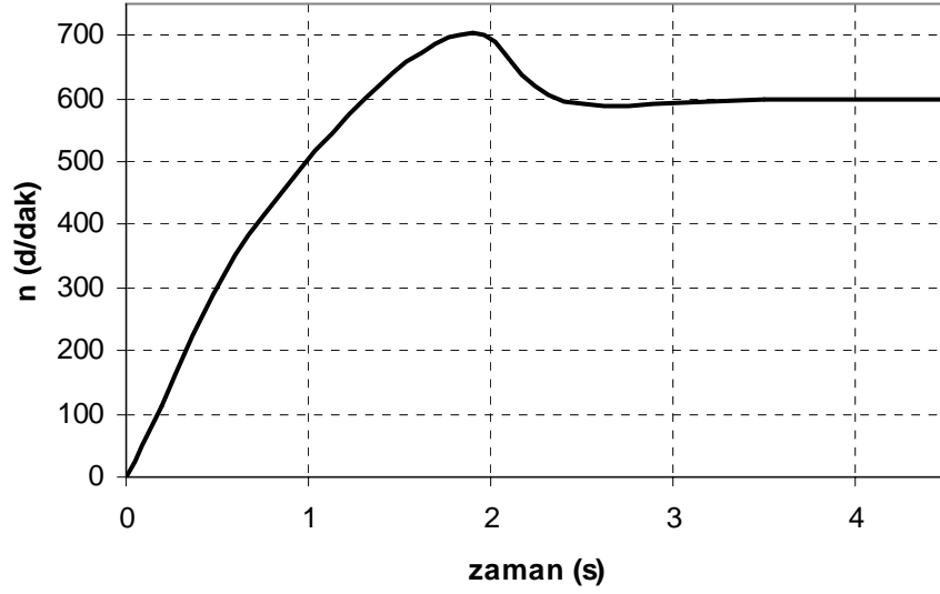
Şekil 5.53 ARM sürücünün n=600 d/dak referans hız V=34 V besleme geriliminde yüklü durumda kapalı çevrim hız kontrolünde ölçülen hızın değişim grafiği ( T_y=0.46 Nm).
