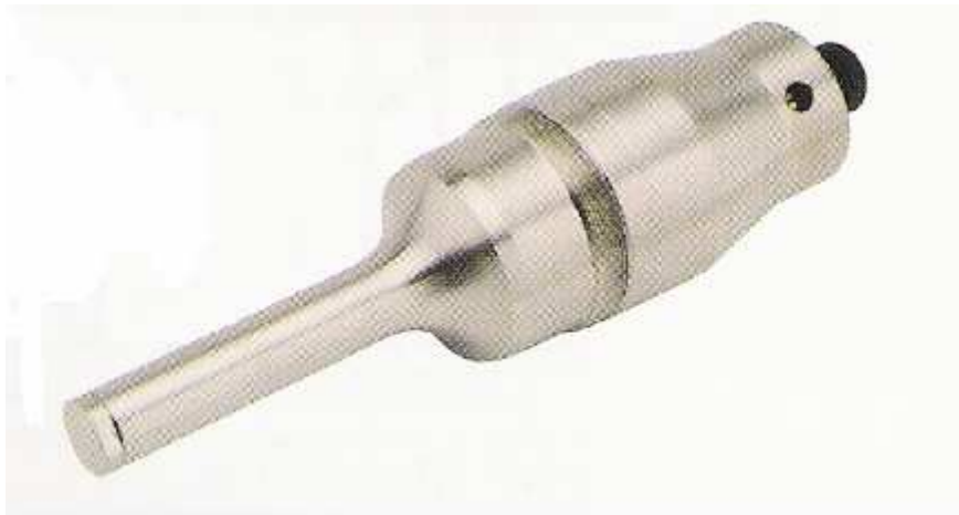
Şekil 2. Sonikasyon işleminde kullanılan 13 mm'lik solid pob
