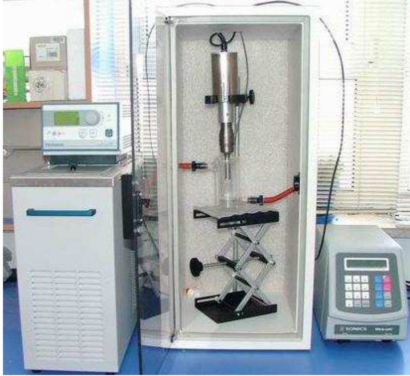
Şekil 1. Sonikasyon işleminin gerçekleştirilmiş olduğu düzenek
