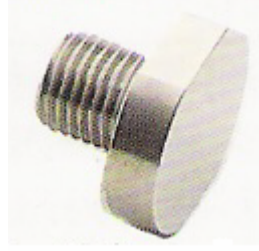
Şekil 3. Sonikasyon işleminde kullanılan 13 mm'lik solid prob'un uç kısmının yakından görünüşü
