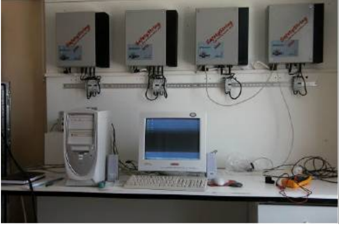
Resim Ek-B-1.1. Çeviriciler ve fotovoltaiik kontrol sistem birimi (Oktik ve diğ. 2005)
