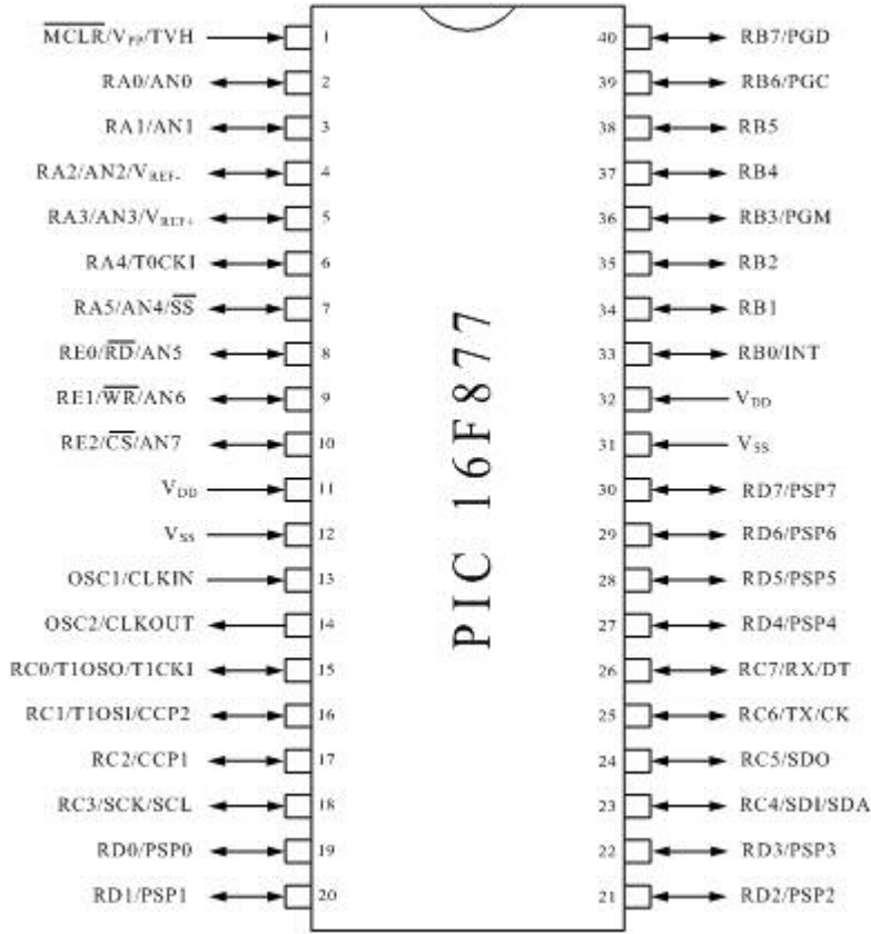
Şekil 4.1. PIC Mikrodenetleyici 16F877'nin yapısı
