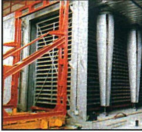
Şekil 3.10. Tünel kurutmanın kesit görünüşü (Nibra-Dach Keramik)
