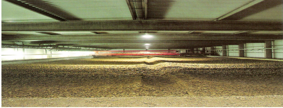
Şekil 3.5. Hammadde hazırlama bölümünde hazırlanan çamurun dinlendirilmesi (Nibra-Dach Keramik)
