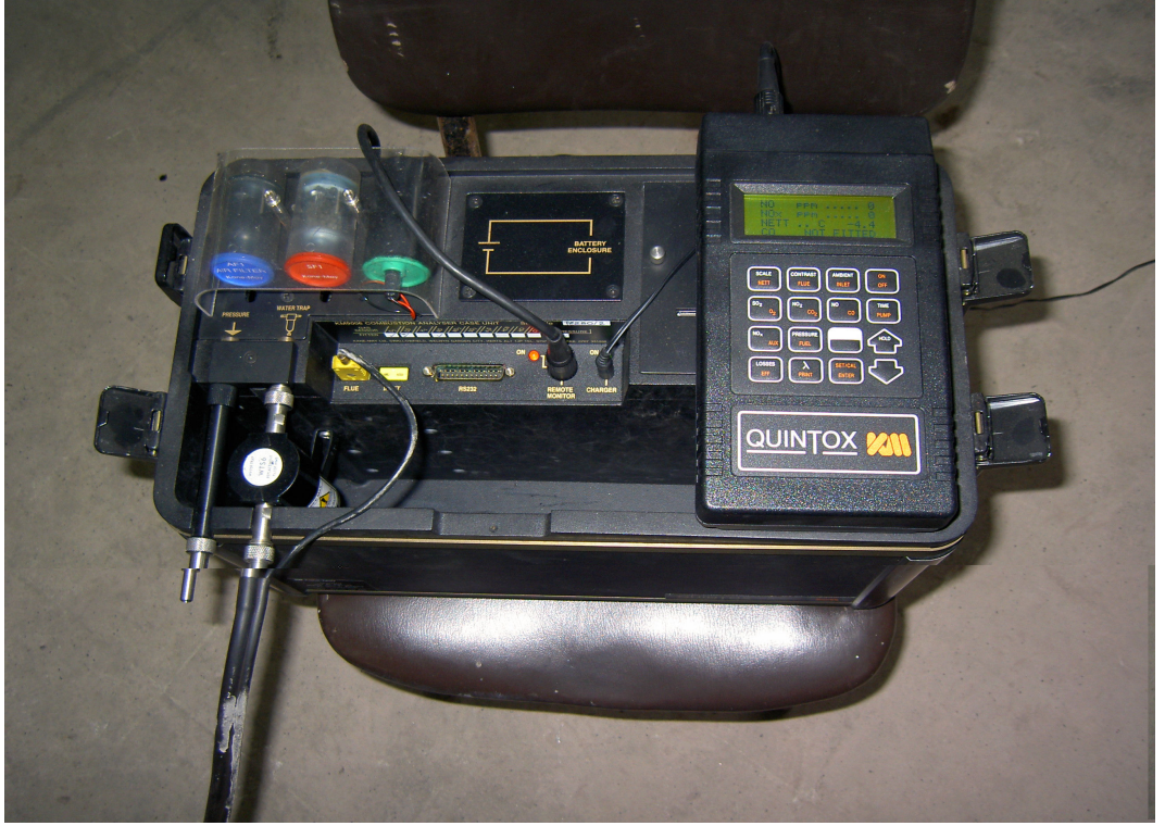
Şekil IV.6 NO x ölçümü için kullanılan Kane-May Quintox marka emisyon test cihazı
