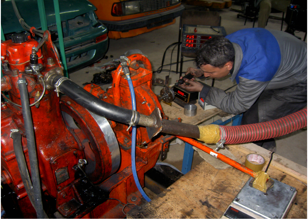
Şekil IV.3 Dinamometre ve motor
