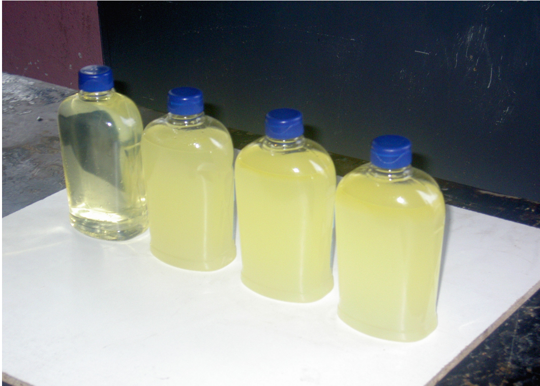
Şekil IV.1 Deneylerde kullanılan yakıtlar, eurodizel ve % 5, 10, 15 oranında etanol-eurodizel karışımları
