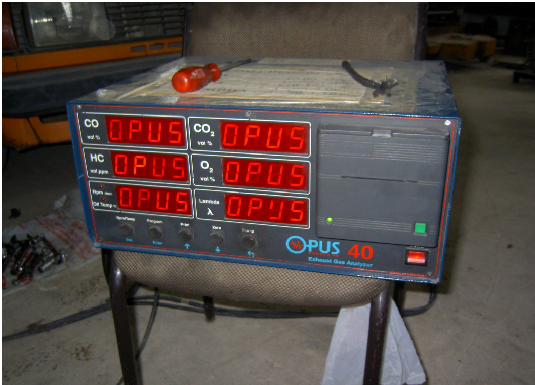
Şekil IV.5 CO, HC, O 2 , CO 2 ve hava fazlalık katsayısı ölçümü için kullanılan Opus 40 marka emisyon test cihazı
