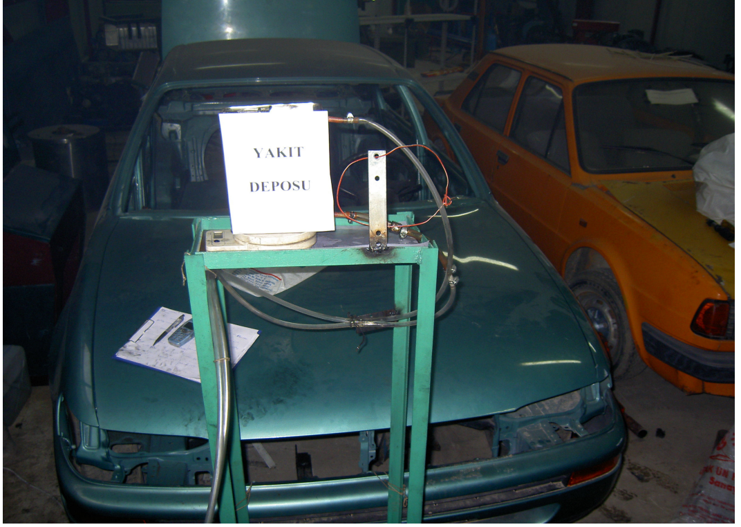
Şekil IV.7 Yakıt debisi ölçüm donanımı
