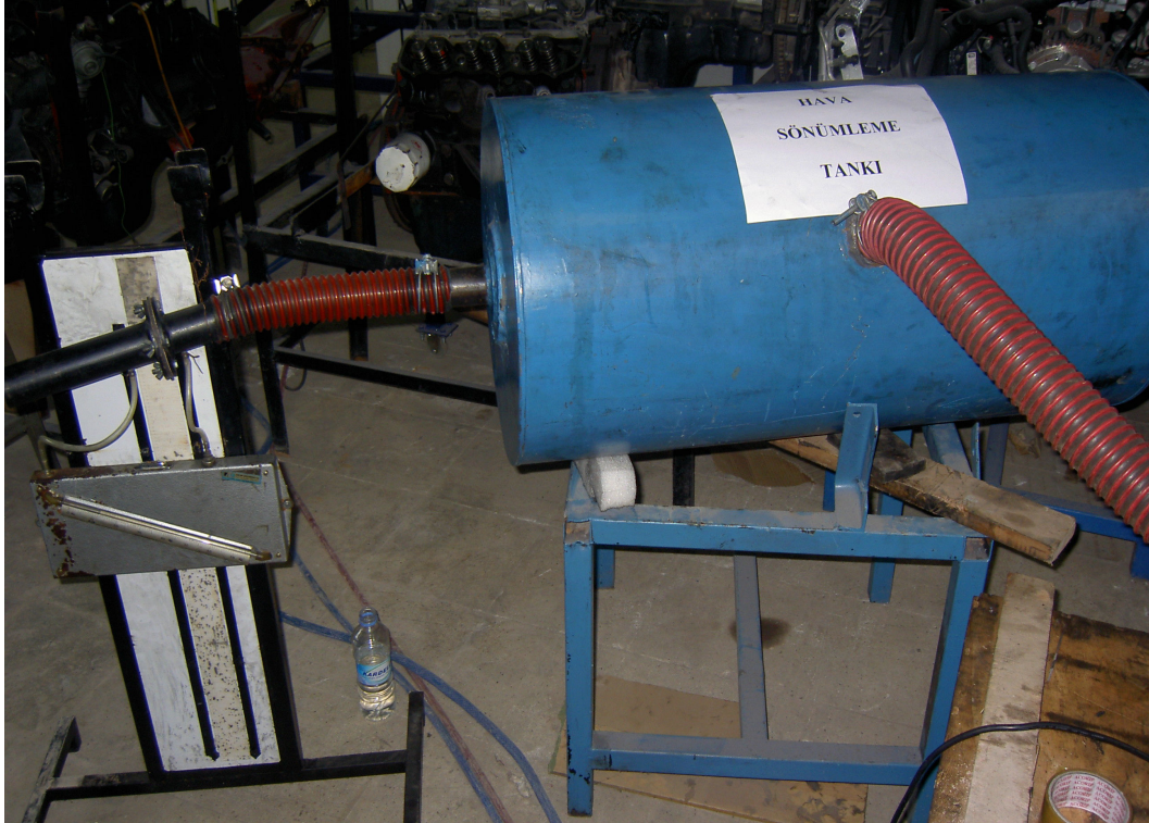
Şekil IV.9 Hava debisi ölçüm donanımı
