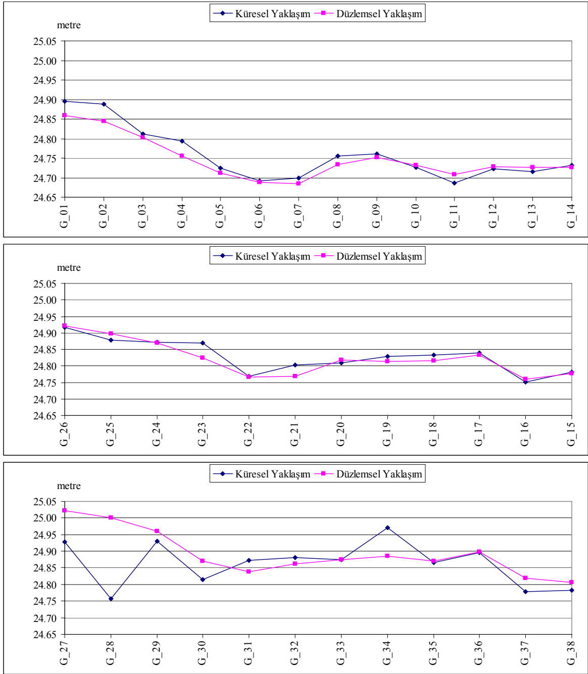
Şekil 56. EGM96 global jeopotansiyel modelin kullanıldığı küresel ve düzlemsel yaklaşımın karşılaştırılması
