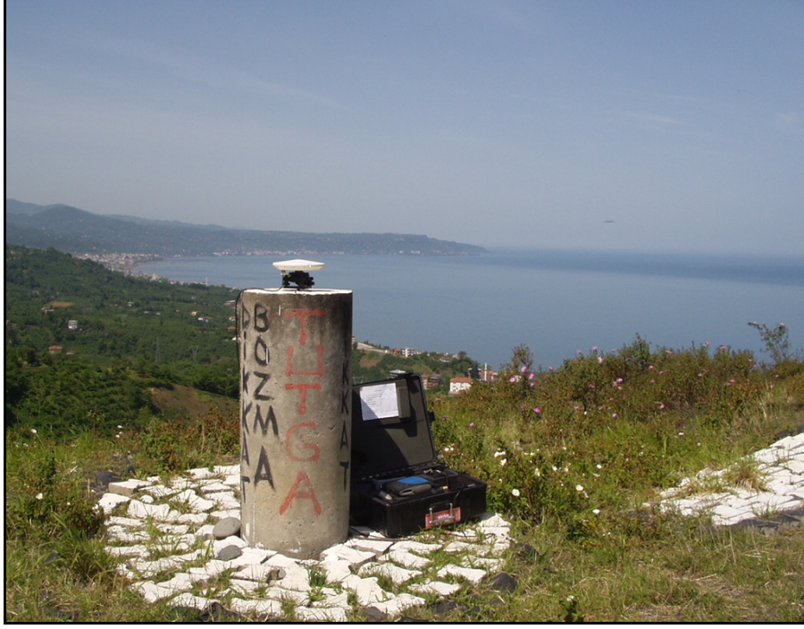
Şekil 26. Pilye olarak inşa edilmiş bir TUTGA noktası (KLKY Çarşıbaşı)
