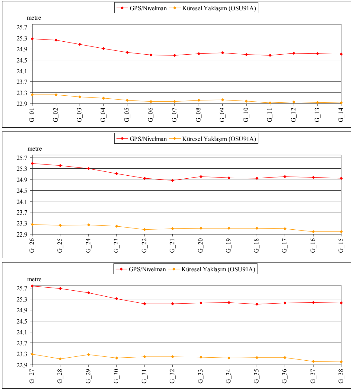
Şekil 61. GPS/Nivelman jeoidi ile OSU91A jeopotansiyel model kullanılarak hesaplanmış küresel yaklaşımli jeoid grafiği
