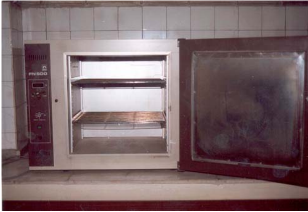
Şekil 3.1. Numunelerin kurutulduğu fırın
