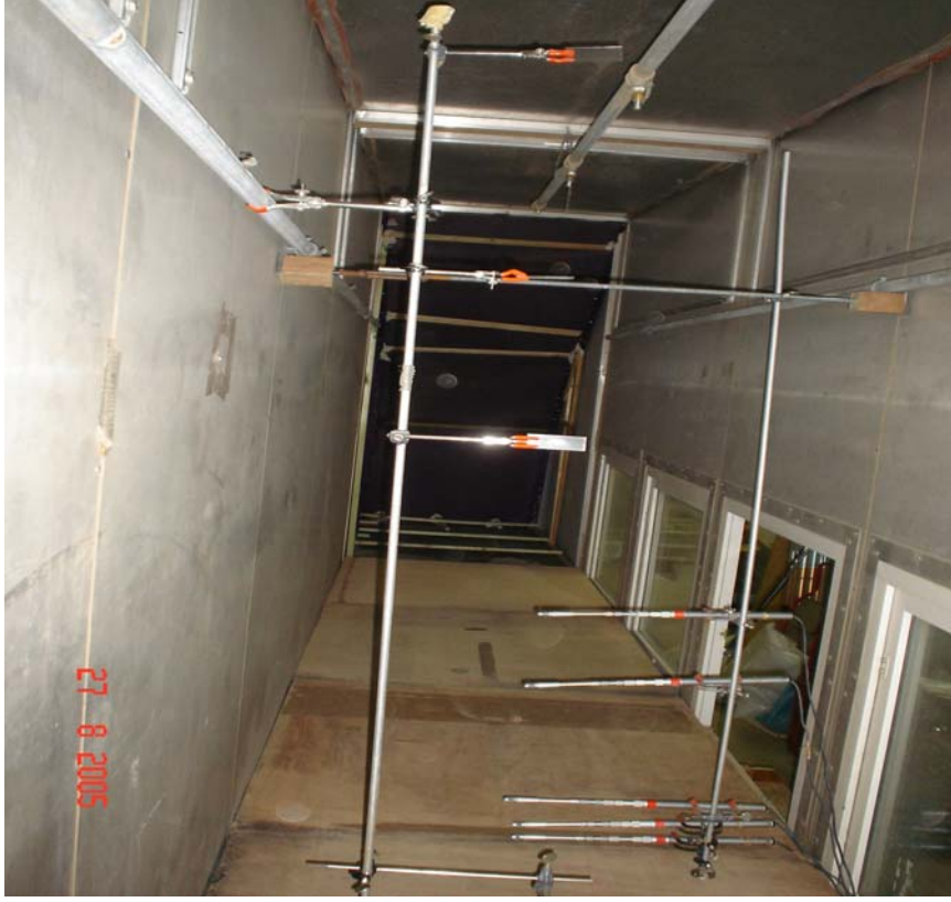
Şekil 3.3 Rüzgar tüneline rüzgar hızını ölçer anemometreler
