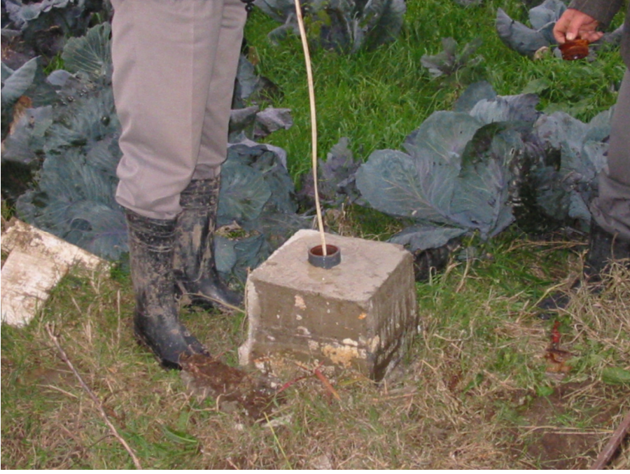
Şekil 4. 2. Taban Suyu Gözlem Kuyusu Ölçümü
