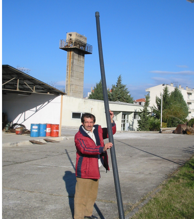
Şekil 3. 3. Taban Suyu Gözlem Kuyusunda Kullanılan PVC Boru
