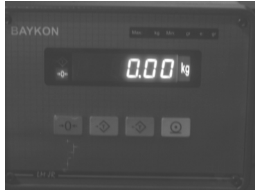
Resim 10.2. Yük uygulanmadan önceki sıfırlanmış gösterge değeri
