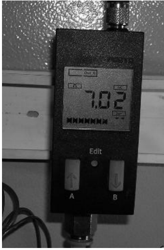
Resim 9.18. Dijital göstergeli analog basınç anahtarı
