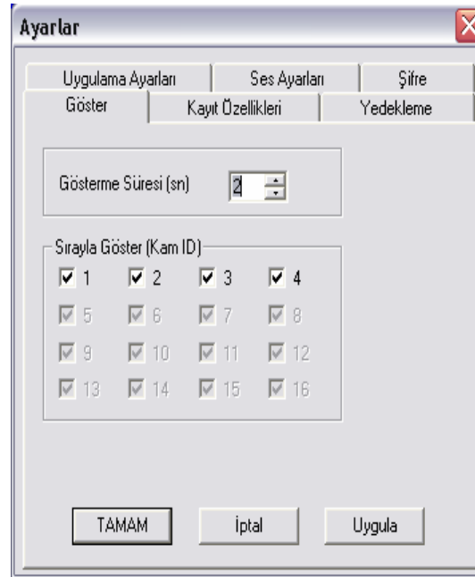
Şekil III.24 Bina güvenlik sistemi CCTV programı genel ayarları
