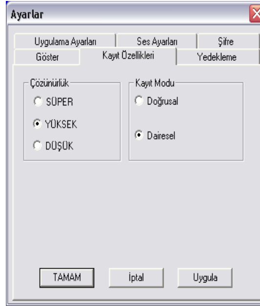
Şekil III.25 Bina güvenlik sistemi CCTV programı kayıt ayarları
