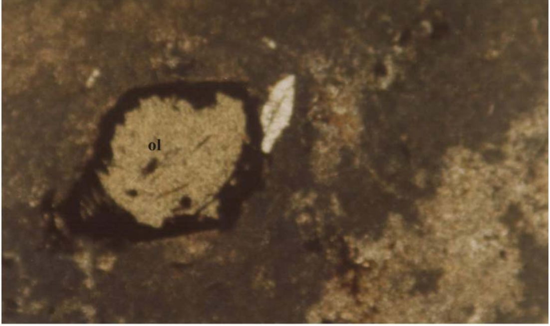
Şekil 3.9: Andezitlerde yer alan olivinlerin (ol) kenarlarında reaksiyon sonucu gelişmiş iddingsitleşmenin görünümü (T.N. X10)
