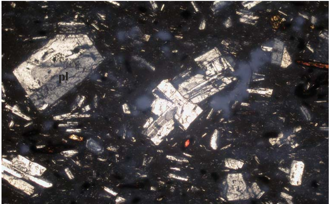
Şekil 3.10: Dasitlerde yer alan plajiyoklaslarda (pl) gelişmiş karlsbad ve albit-karlsbad ikizlerinin görünümü (Ç.N. X4)
