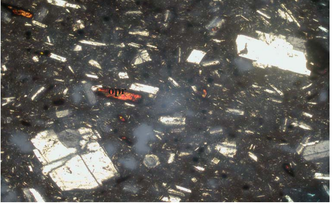
Şekil 3.13: Dasitlerde yer alan prizmatik ve çubuksu ortopirosenlerin (opr) görünümü (Ç.N. X4)
