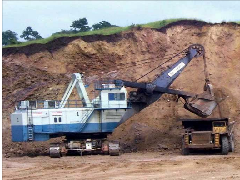
Şekil 3.4. Elektrikli ekskavatör – kamyon örtü kazı çalışması
