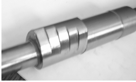
Resim 4.3. İmalatı yapılan değişken emme supabı kapanma zamanlamasına sahip kam mili
