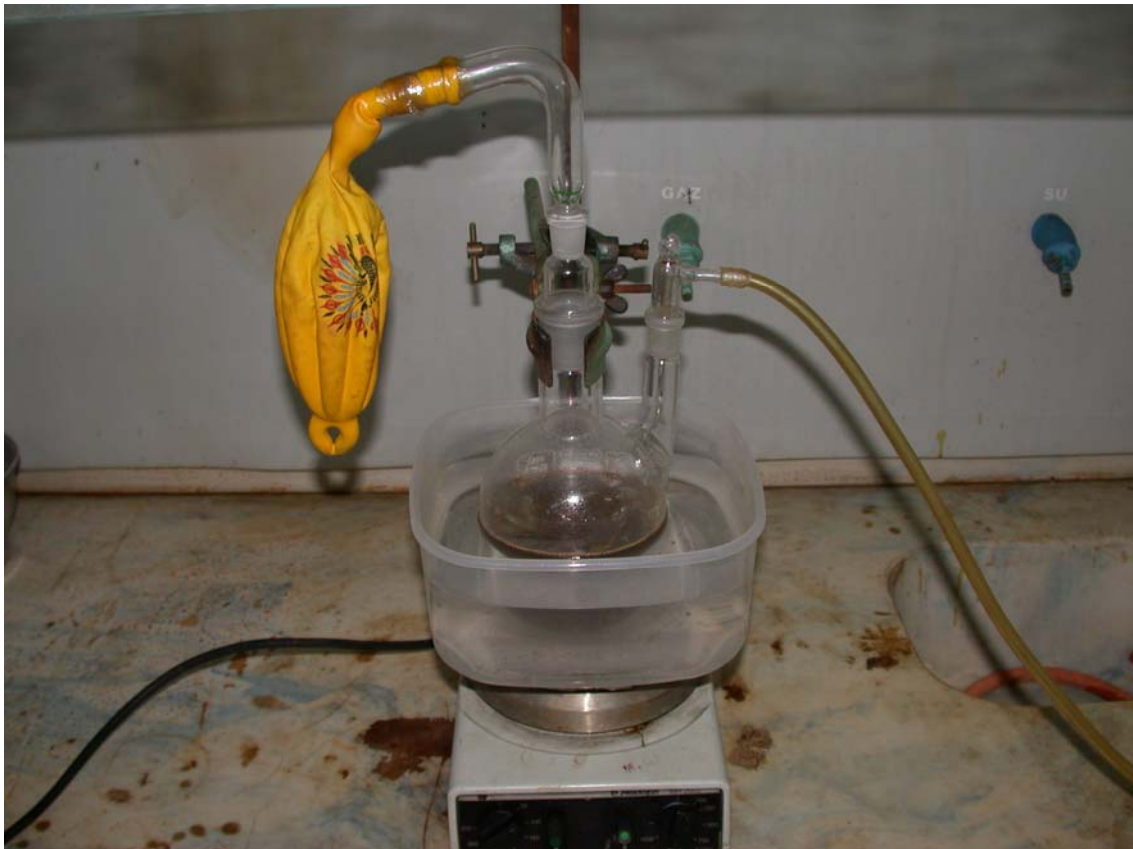
Şekil 3.1. Benzenin prosedür I 'e göre indirgeme deneyinde, reaksiyon başlangıcından 4 saat sonra çekilen deney düzeneğinin fotoğrafı.
