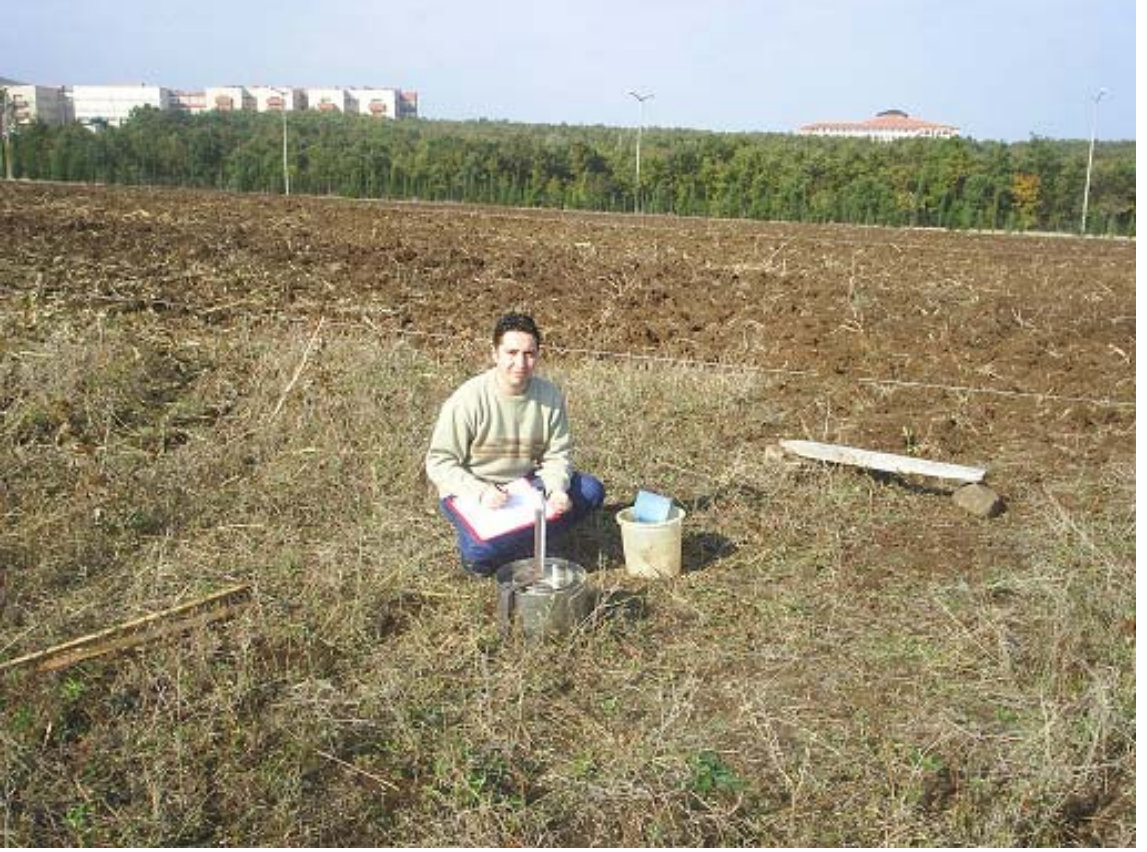
Resim 3. İnfiltasyon testinin yapılması
