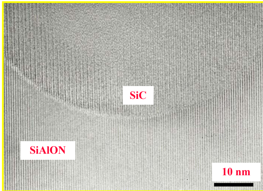
Şekil 7.6. %25 SiC içeren \alpha -SiAlON numunesine ait HR-TEM görüntüsü
