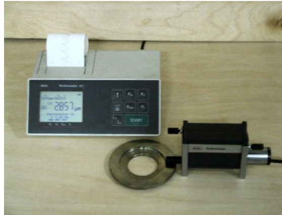
Şekil 13.7 Mahr Perthometer M1 pürüzlülük ölçüm cihazı
