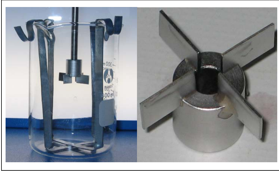
Şekil 3.5. Karıştırıcılı reaktör ve 4 düz bıçaklı karıştırıcı
