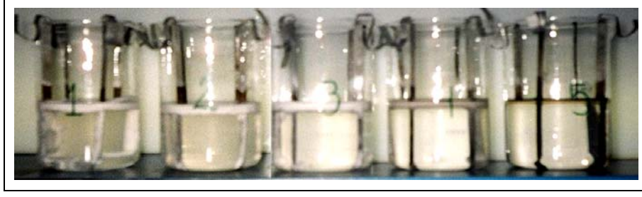
Şekil 4.8. Yüzey aktif madde miktarının değişiminin kurşun giderimi üzerine etkisinin incelendiği arıtım sonrası ELM sistemlerinin fotoğrafı
