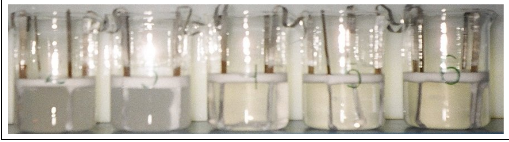
Şekil 4.21. Dış faz pH değeri değişiminin kurşun giderimi üzerine etkisinin incelendiği arıtım sonrası ELM sistemlerinin fotoğrafı
