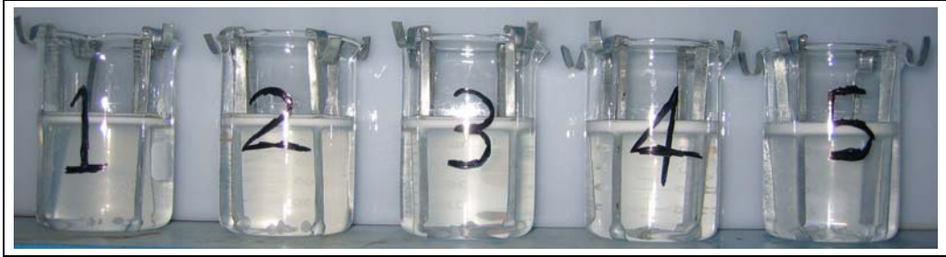
Şekil 4.38. Optimum pH değerine ayarlanmış dış fazın kurşun konsantrasyonunda ve KOİ yükündeki değişimin kısa periyotta incelenmesi amacıyla yapılan çalışmada kullanılan ELM sistemlerinin arıtım sonrası görünümü
