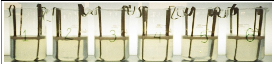
Şekil 4.25. Dış faza organik ligand ilavesinin kurşun giderimi üzerine etkisinin incelendiği arıtım sonrası ELM sistemlerinin fotoğrafı
