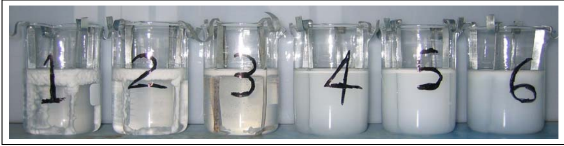
Şekil 4.30. Farklı yüzey aktif madde ve organik çözücülerin dış faz KOİ yüküne olan etkilerinin incelendiği arıtım sonrası ELM sistemlerinin fotoğrafı
