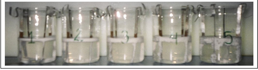
Şekil 4.16. İç sucul faz normalitesindeki değişimlerin kurşun giderimi üzerine etkilerinin incelendiği arıtım sonrası ELM sistemlerinin fotoğrafı
