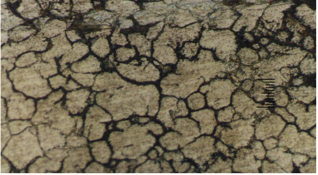
Şekil 4.2: 1030°C sıcaklıkta 30 dakika süreyle östenitlenen H13 sıcak iş takım çeliğinin mikroyapısı, (10 haneli marker \equiv 20 \mu m)
