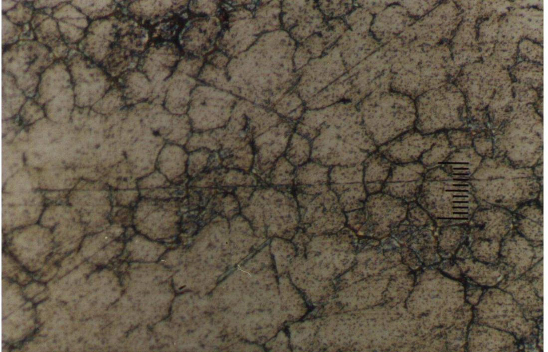
Şekil 4.5: 1050°C sıcaklıkta 90 dakika süreyle östenitlenen H13 sıcak iş takım çeliğinin mikroyapısı, (10 haneli marker \equiv 20 \mu m)
