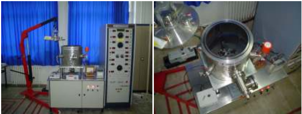
Şekil 5.1. TVA sisteminin önden ve üstten görünüşü.
