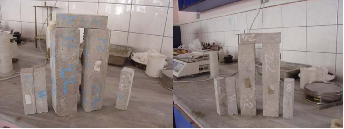
Fotoğraf 8.1. Numuneler 500 °C’de ısıl işleme girmeden önce (sol) ve sonra (sağ)
