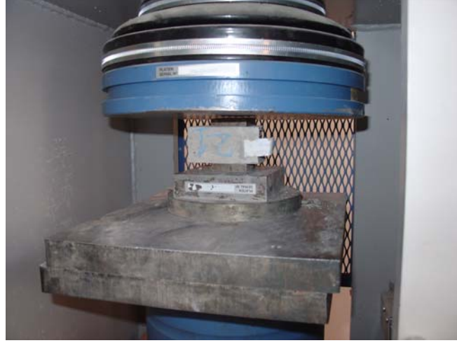
Fotoğraf 6.5. Harç numunelerine basınç dayanımı deneyi uygulanması
