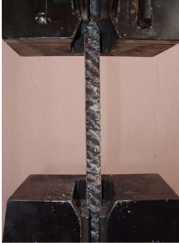
Fotoğraf 8.2. 950 °C'de ısıl işlem gören pas paysız donatının yüzeyindeki kabuk atma
