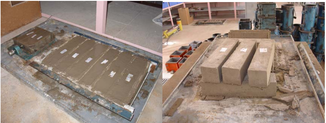
Fotoğraf 6.2. Harç numunelerinin hazırlanması
