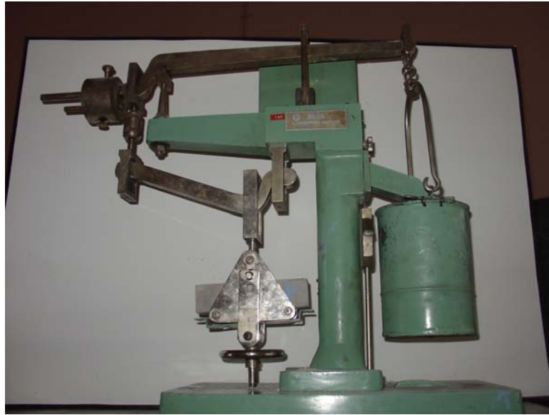
Fotoğraf 6.4. Harç numunelerine eğilme dayanımı deneyi uygulanması
