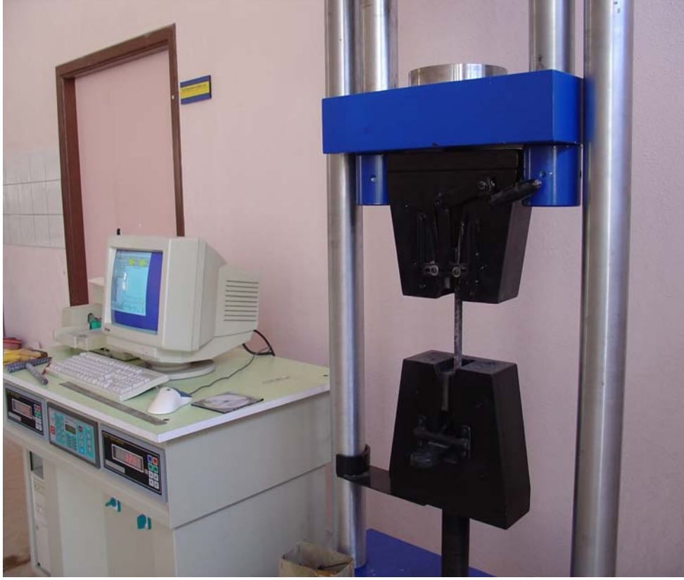
Fotoğraf 6.7. Çekme deneyinde kullanılan üniversal çekme makinesi
