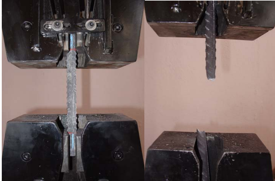
Fotoğraf 6.8. Çekme deneyi uygulanan donatı
