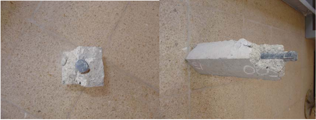
Fotoğraf 7.2. Isıl işleme tabi tutulmuş numunenin koruyucu pas payından ayrılması.
