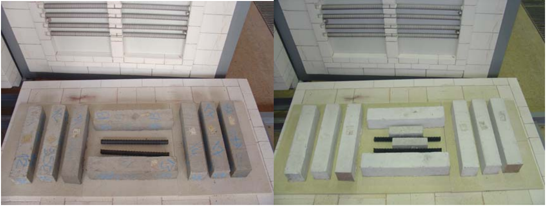
Fotoğraf 7.1. Numuneler 950 °C’de ısıl işleme girmeden önce (sol) ve sonra (sağ)
