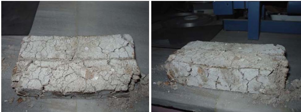
Fotoğraf 8.4. 950 °C'den çıkmış ve 240 saat beklemiş harç numuneleri
