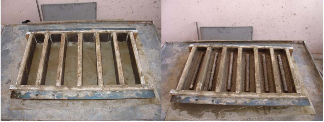
Fotoğraf 6.1. Kalıplar ve harç numunelerine donatının yerleştirilmesi
