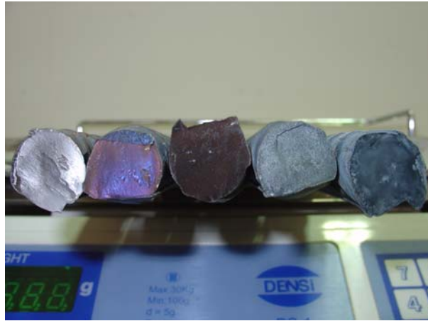
Fotoğraf 7.3. Soldan sağa 20 °C de tutulmuş, 300, 500, 800 ve 950 °C'de ısıl işlem görmüş pas paysız numunelerdeki renk farklılığı.
