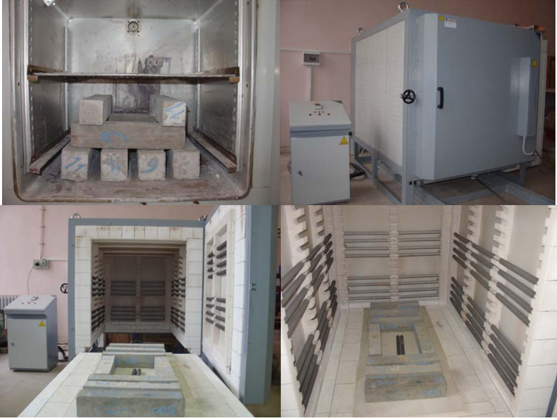
Fotoğraf 6.6. Yüksek sıcaklık deneyinde kullanılan fırın ve etüv
