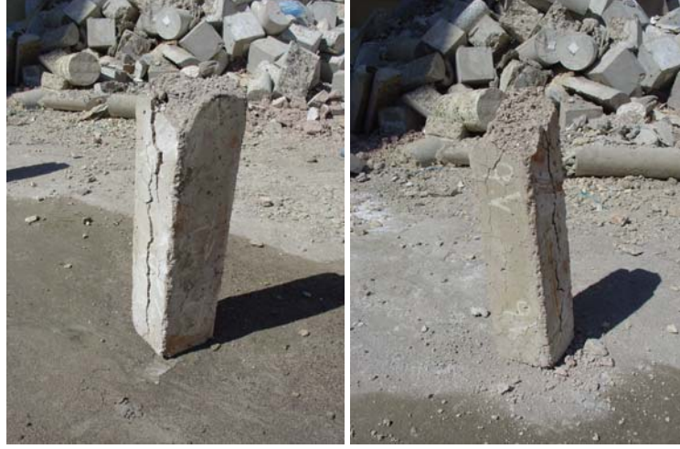
Fotoğraf 8.3. 950 °C'den çıkmış ve 72 saat beklemiş numuneler
