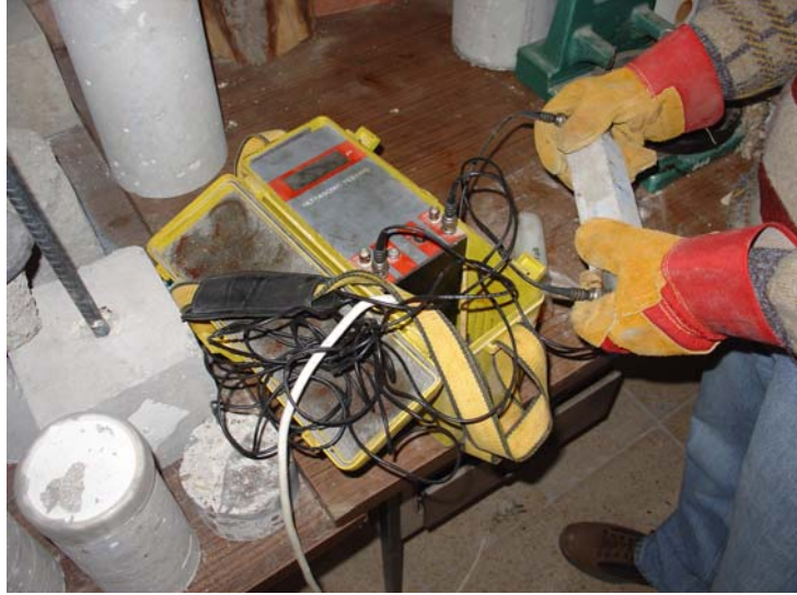
Fotoğraf 6.3. Har numunelerine ultrases geiş süresi deneyi uygulanması
