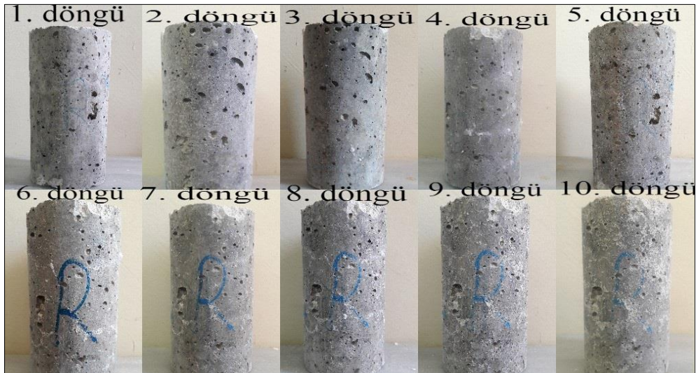
Şekil 3.17. Antifriz katkısız %5 tuz içerikli normal şartlarda üretilen hafif beton numunesinin değişimi
