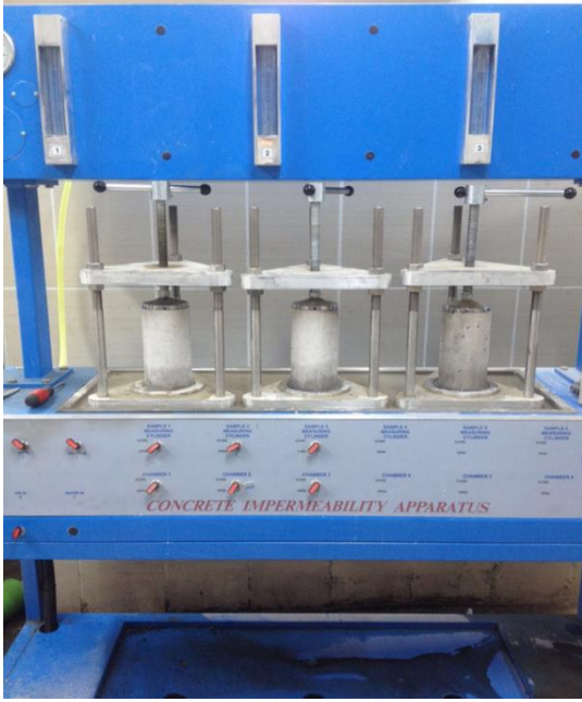
Şekil 2.6. İmpermeabilite cihazı
