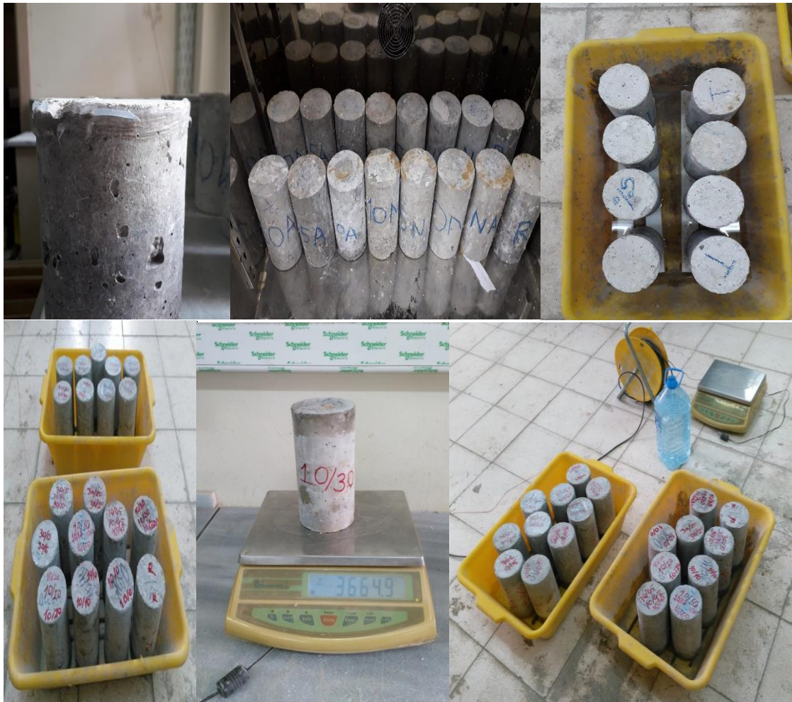
Şekil 2.5. Kapilerite deney düzeneği
