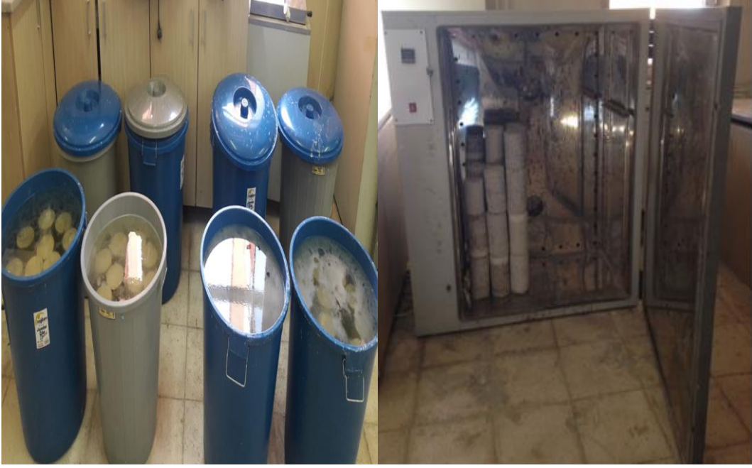
Şekil 2.7. Sülfat ve Tuz deneyi döngüsü
