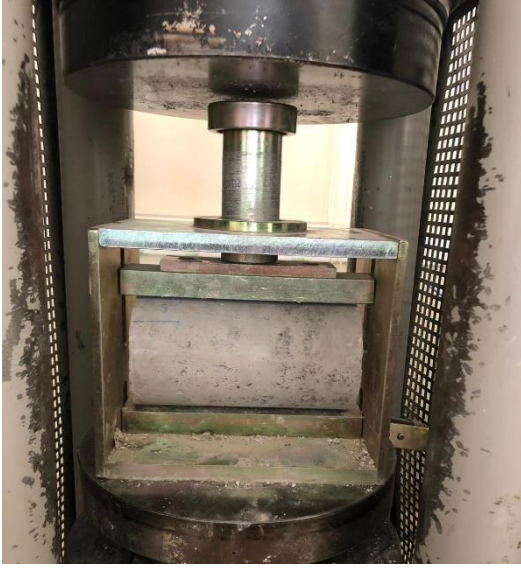
Şekil 2.4. Yarmada çekme deney düzeneği
