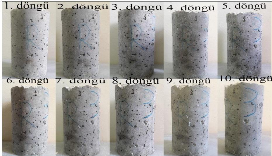
Şekil 3.25. Antifriz katkısız %5 sodyum sülfat içerikli normal şartlarda üretilen hafif beton numunesinin değişimi
