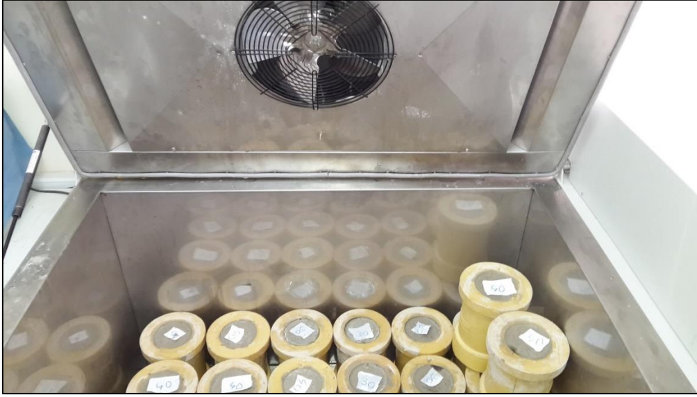
Şekil 2.2. Dona maruz bırakılan beton örnekler
