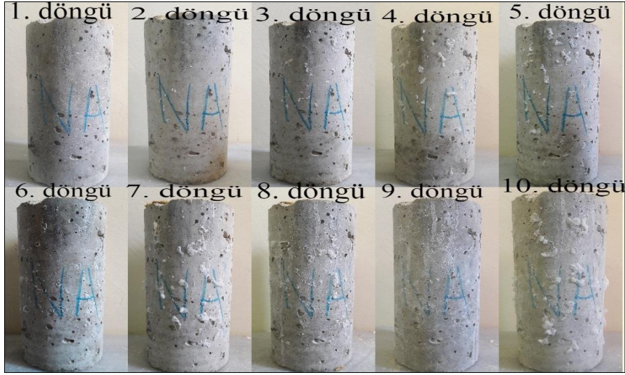
Şekil 3.30. Antifriz katkılı %10 sodyum sülfat içerikli normal şartlarda üretilen hafif beton numunesinin değişimi
