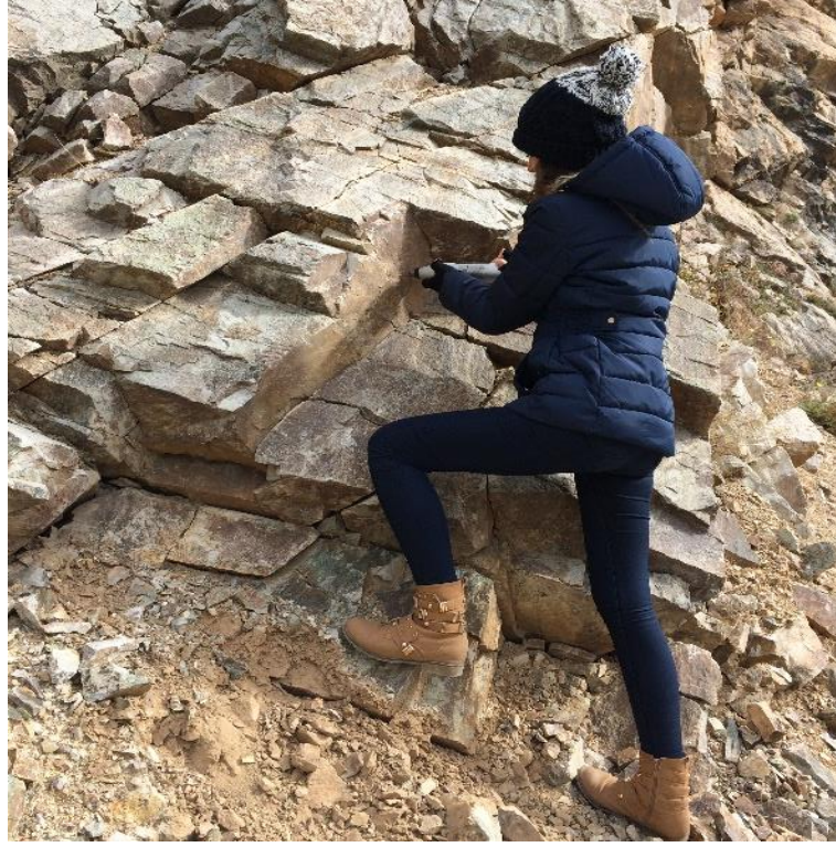
Şekil 3.15. Süreksizlik yüzeylerinde Schmidt çekici deneyi
