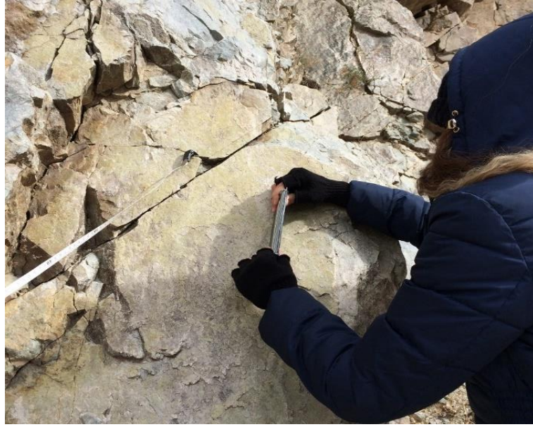
Şekil 2.3. Şev süreksizliklerinden alınan pürüzlülük ölçümü
