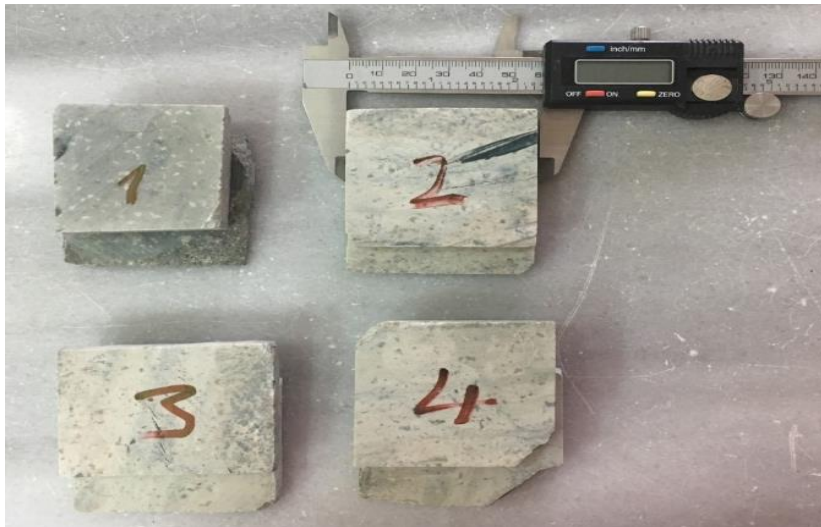
Şekil 3.17. Dasitlere ait makaslama deneyi örnekleri
