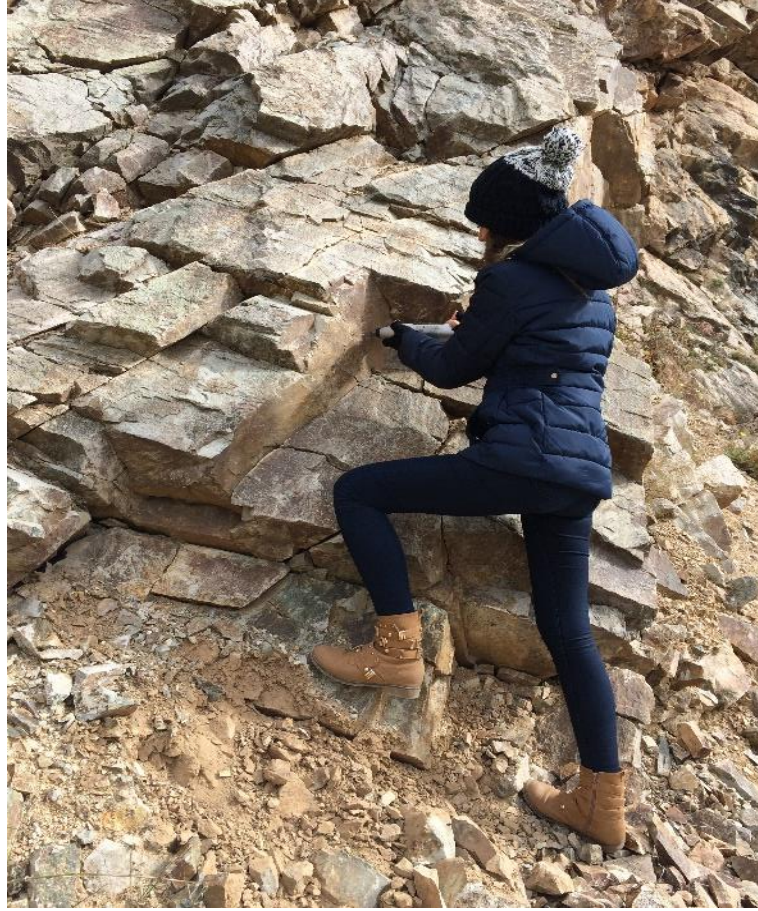
Şekil 2.5. Arazide süreksizlik yüzeylerinde Schmidt çekici deneyi
