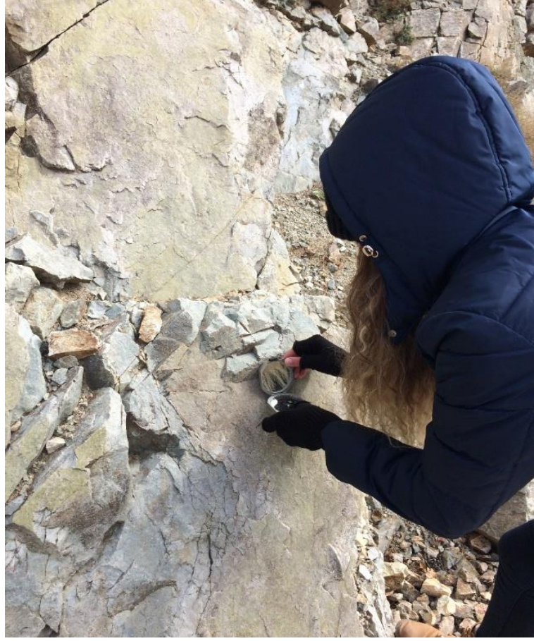
Şekil 2.2. Süreksizlik yönelimlerinin pusula ile ölçümü
