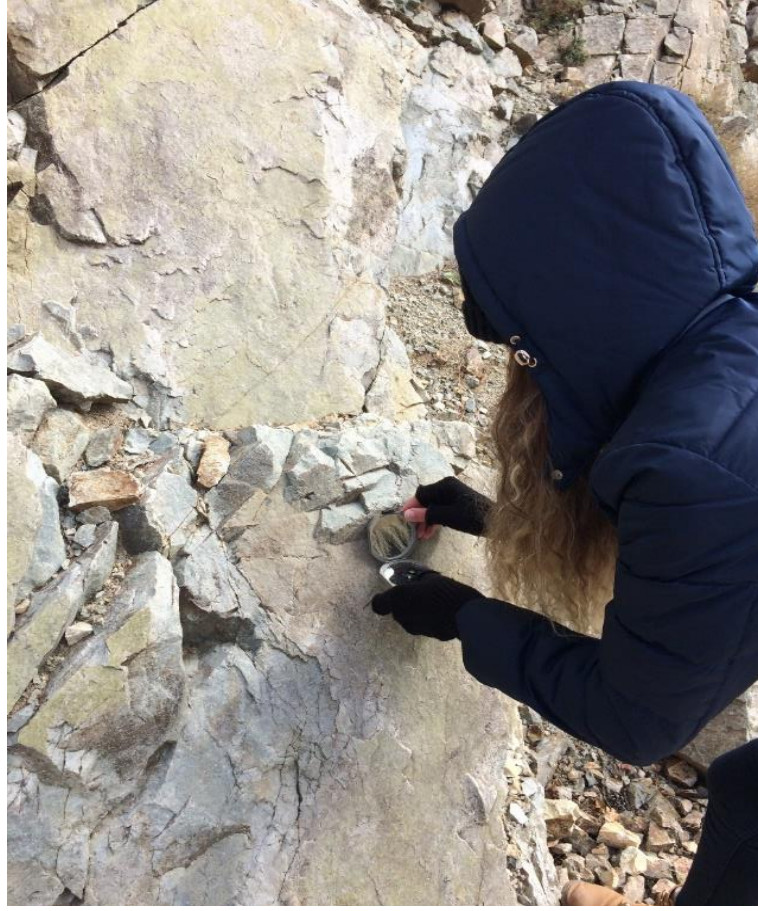
Şekil 3.7. Süreksizlik yönelimlerinin pusula ile ölçümü
