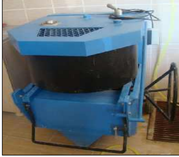
Şekil 3.5. Düşey eksenli cebri karıştırma mikser
