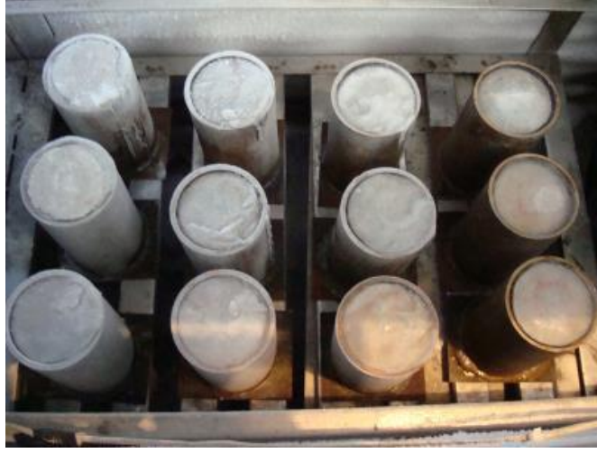
Şekil 3.14. Donma çözülme cihazı
