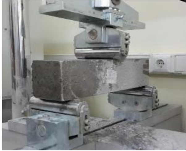
Şekil 3.11. Eğilme basınç presi
