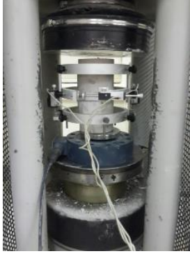
řekil 3.12. Deformasyon deđerlerini belirlemede kullanılan kompressometre
