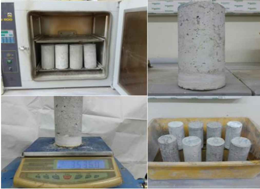
Şekil 3.16. Kapilerite deney düzeneği
