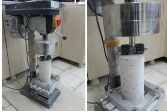
Şekil 3.15. Aşındırma testi cihazı
