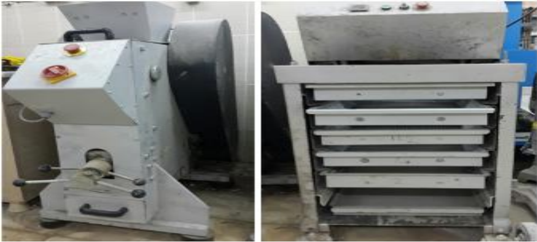
Şekil 3.1. Çeneli kırıcı ve elek sarsma makinası
