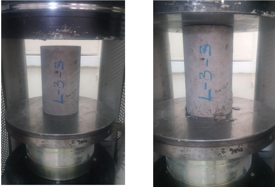
Şekil 2.15. Uygulanan yük altındaki silindir numune
