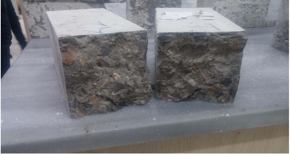
Şekil 2.18. Kırılan beton kiriş numunesi
