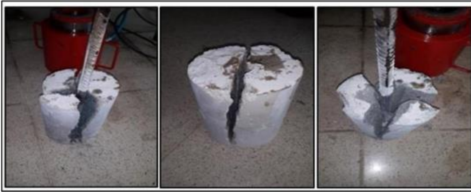
Şekil 1.15. Numunelerin çekip çıkarma deneyinde kırılma şekli
