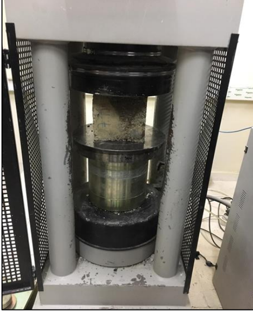
Şekil 2.7. Beton basınç dayanım cihazı
