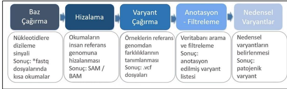
Şekil 1. 8: Kullanılan biyoinformatik iş akışı [33]. (Şekil, Kaynak [33]’den alıntılanarak Türkçeleştirilmiştir.) (Nedensel Varyantlar: Causal Variants)
