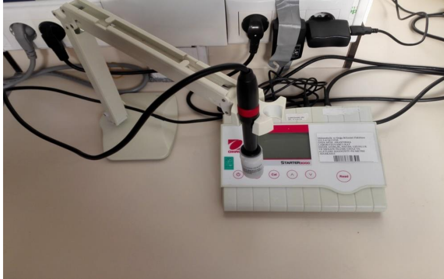
Şekil 2.2. Analizde kullanılan pH cihazı
