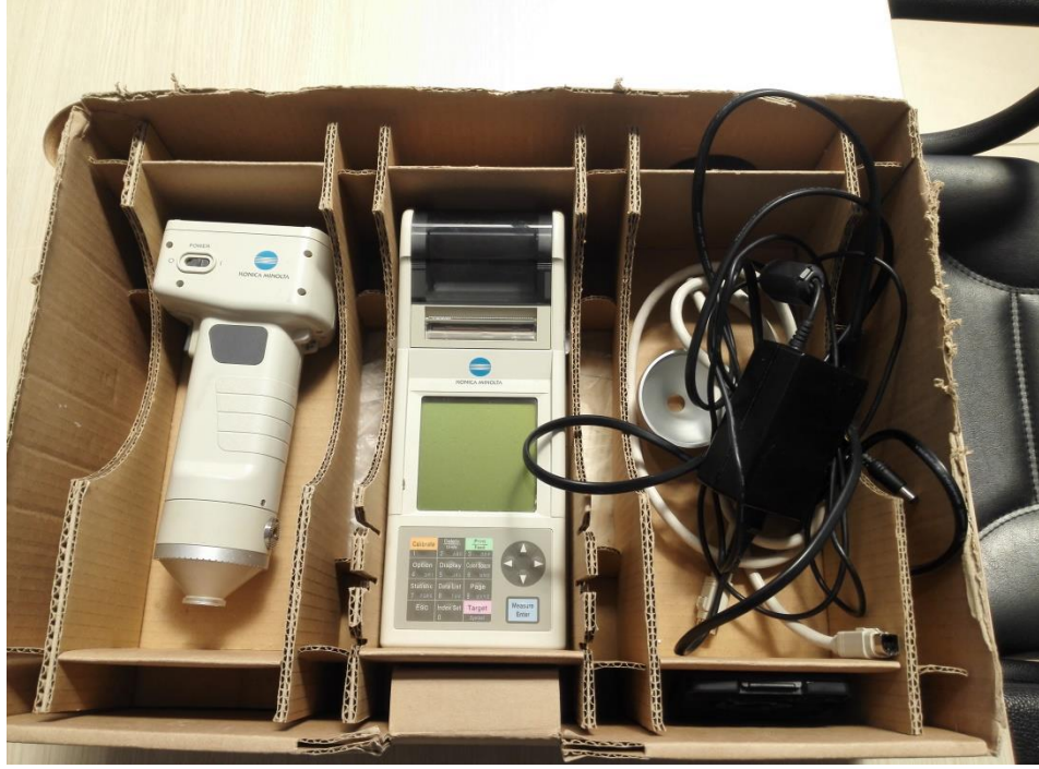
Şekil 2.3. Analizde kullanılan Hunter Kolorimetresi
