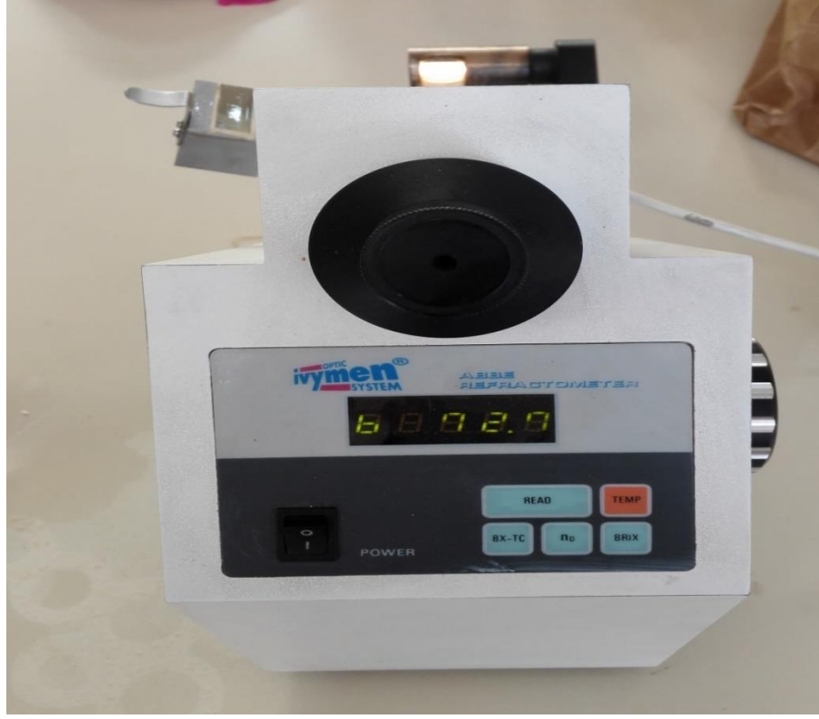
Şekil 2.1. Analizde kullanılan refraktometre cihazı
