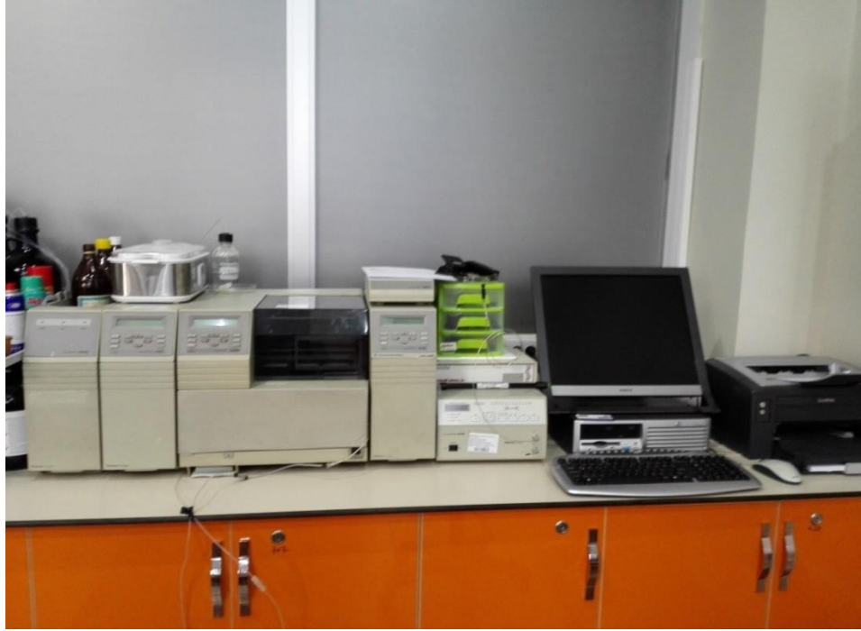
Şekil 2.6. Analizde kullanılan HPLC cihazı
