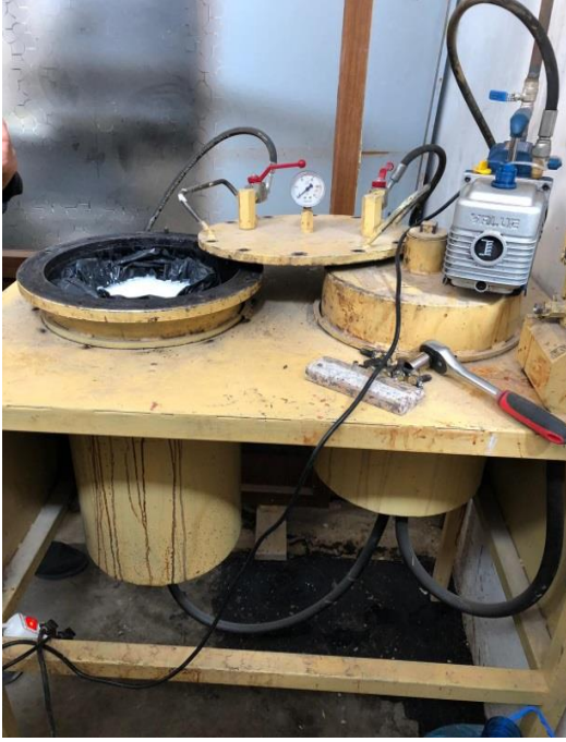
Şekil 2.4. Çalışmada kullanılan emprenye kazanı
