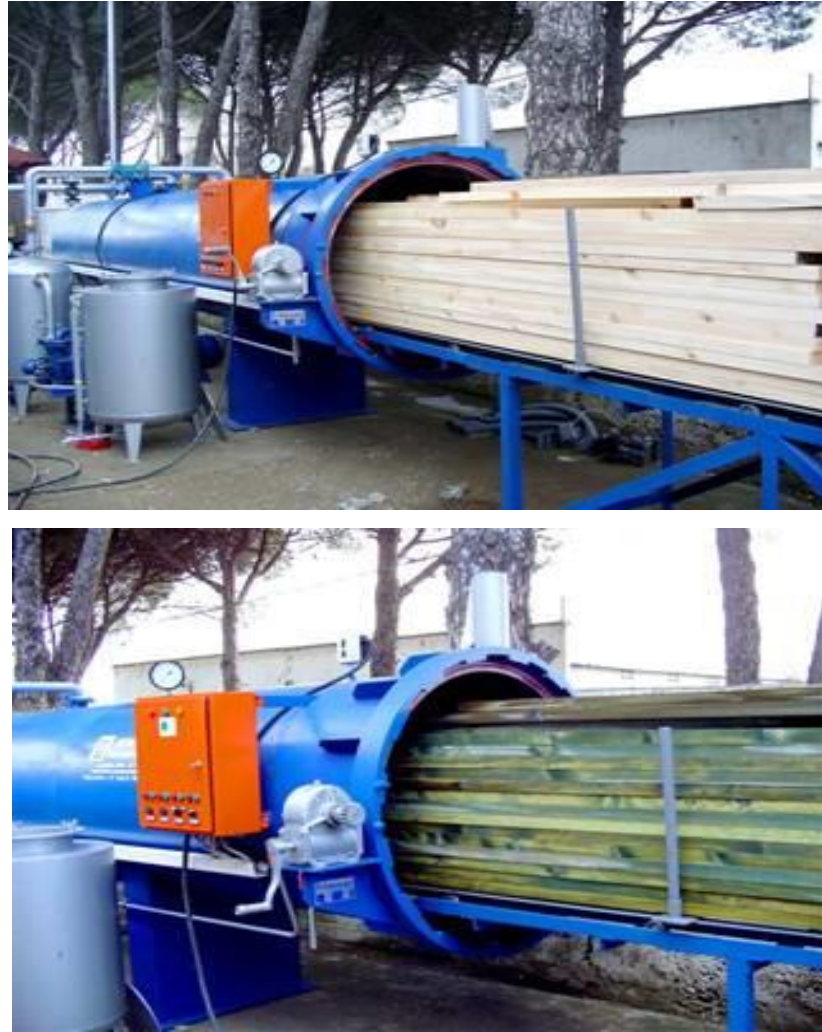
Şekil 1.1. Dolu hücre metoduna göre emprenye yapan bir basınç kazanı (URL, 2007).
