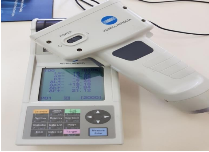
Şekil 2.2. Pomolojik özelliklerin belirlenmesinde kullanılan renk ölçer cihazı
