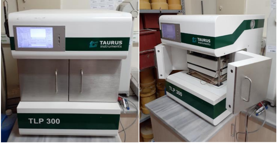
Şekil 3.6. Taurus TLP 300 Isı iletim katsayısı tespit cihazı
