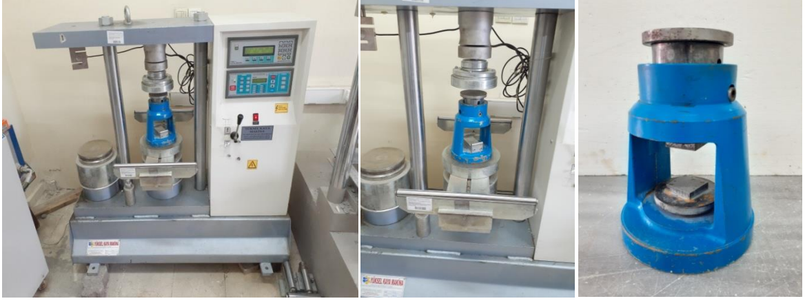
Şekil 3.15. Basınç dayanım deneyi testinde kullanılan makine ve aparat
