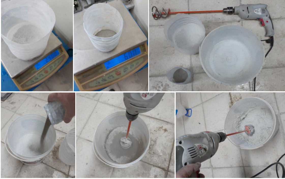
Şekil 3.4. Numune karışımlarının hazırlanışı
