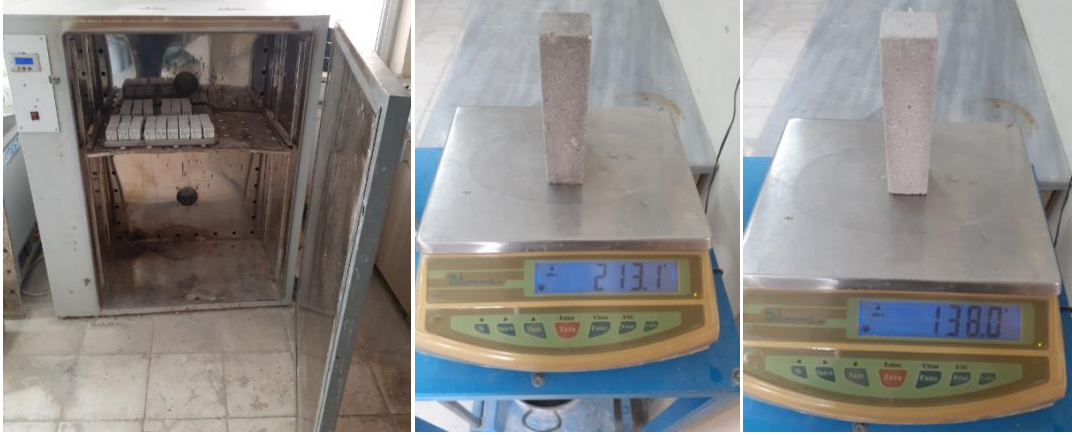
Şekil 3.18. Numunelerin etüvde kurutulması ve ağırlıklarının ölçülmesi
