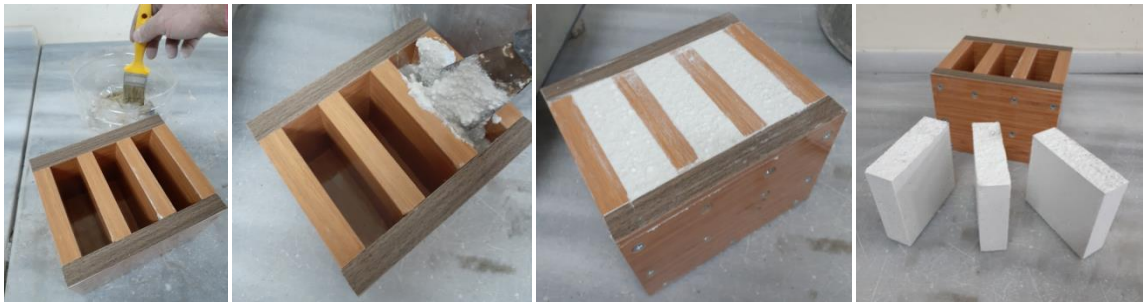
Şekil 3.5. Numune karışımlarının kalıba dökülmesi
