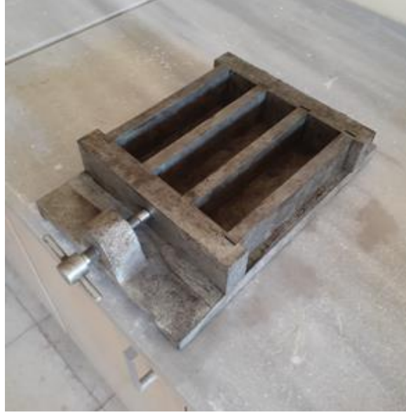
Şekil 3.11. Eğilme ve basınç deneyi için numune kalıbı
