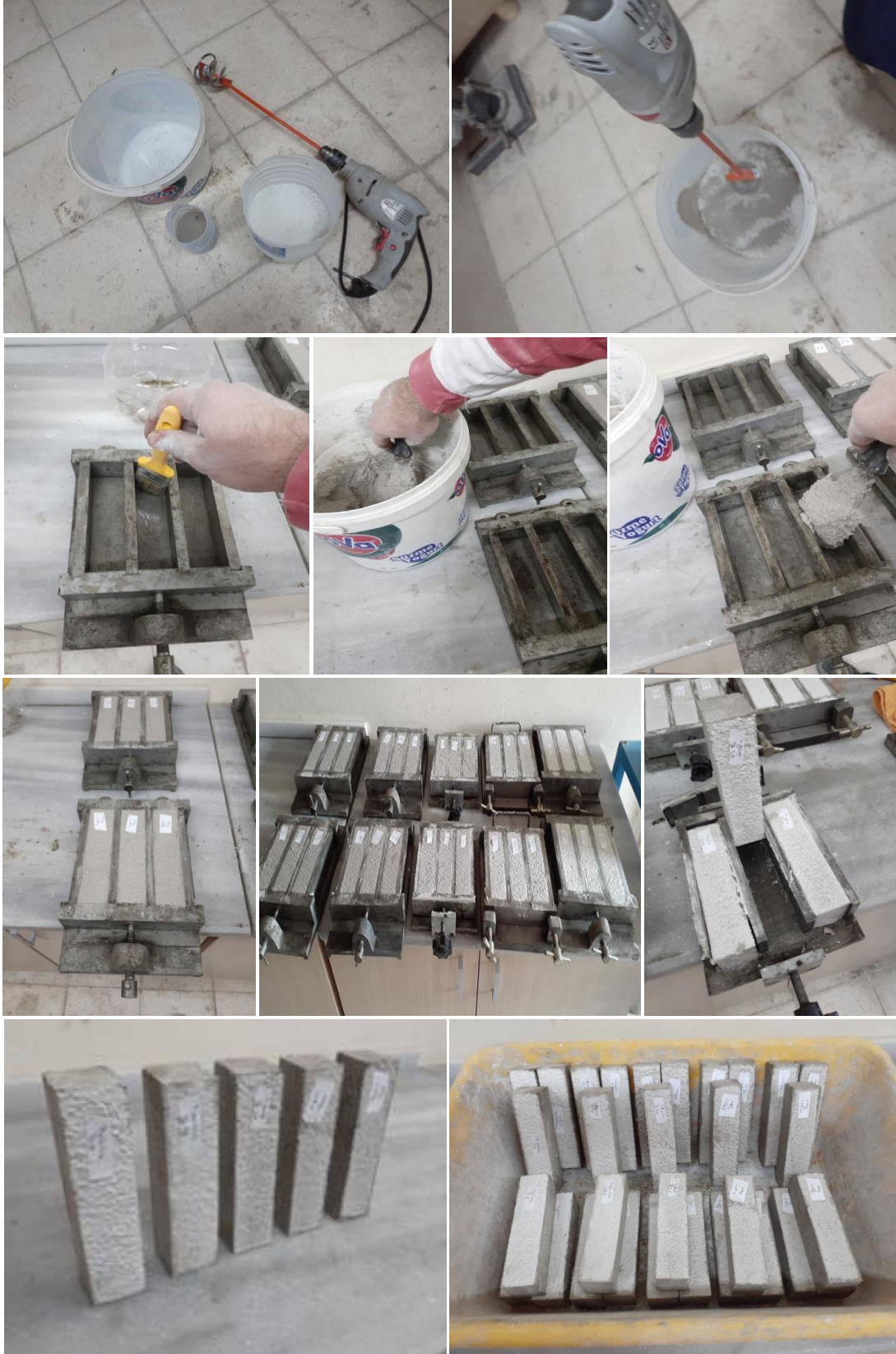
Şekil 3.12. Üretilen eğilme ve basınç deneyi numuneleri
