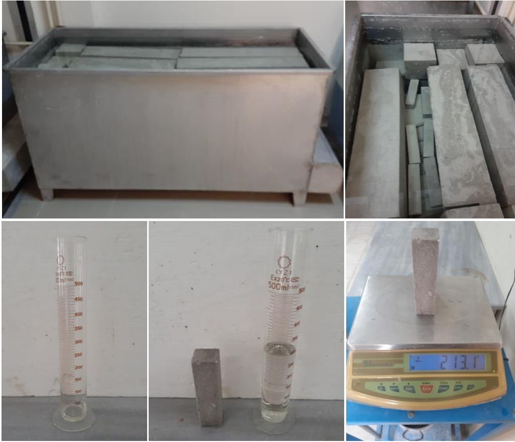
Şekil 3.17. Numuneleri havuzda bekletilmesi ve yoğunluk tayini
