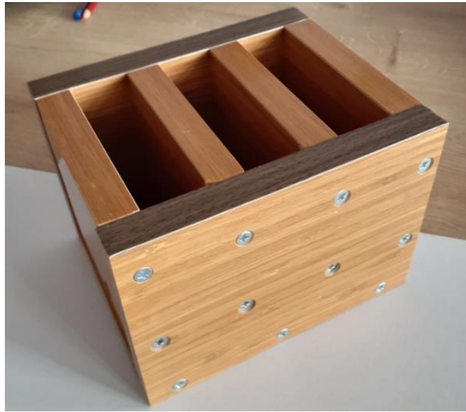
Şekil 3.3. Isı iletim katsayısı tespiti için numune kalıbı
