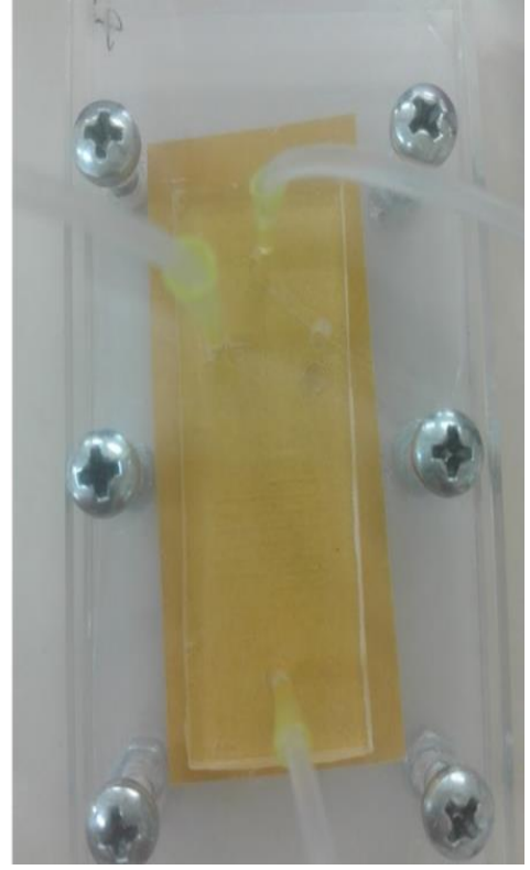
Şekil 5.2. Pleksiglass levhaları ile sıkıştırılarak çalıştırılan mikroçip
