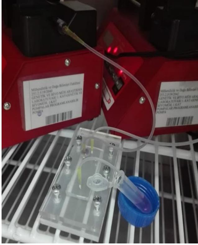
Şekil 5.2. Pleksiglass levhaları ile sıkıştırılarak çalıştırılan mikroçip
