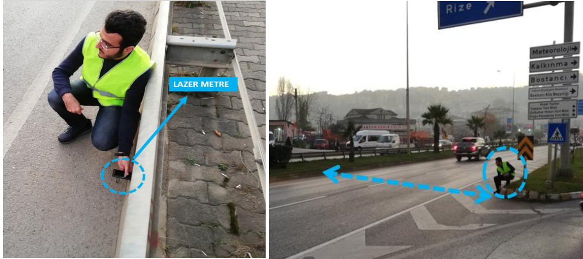
Şekil 2.10. İncelenen yol kesimlerinin geometrik ölçümlerinin yapılması
