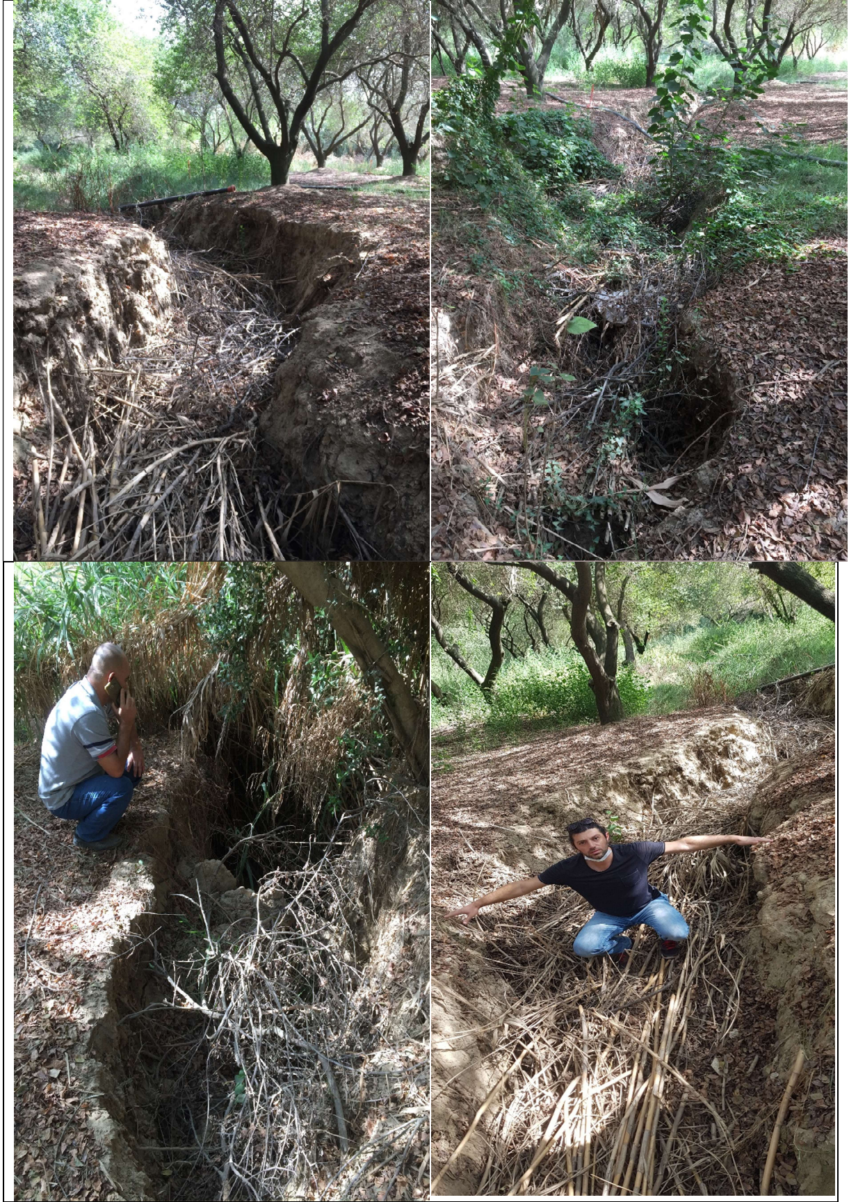
Şekil 4.22. Yolüstü Köyü (Ödemiş) civarında gözlemlenen zemin çökmeleri ve yarılmalar
