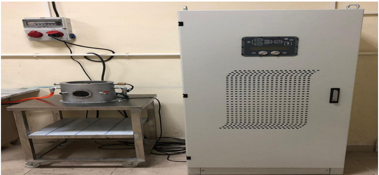
Şekil 2.1. Mikro Ark Oksidasyon Cihazı
