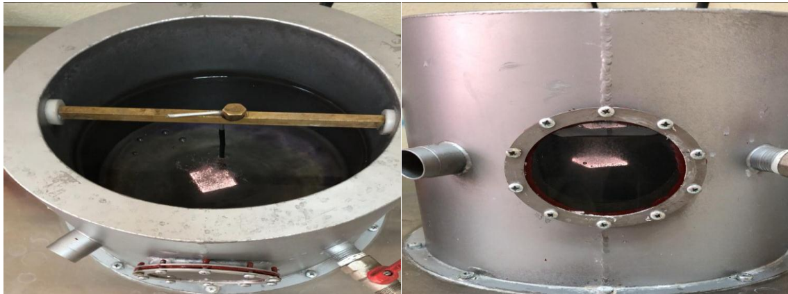
Şekil 2.2. Mikro Ark Oksidasyon Kaplama İşlemi
