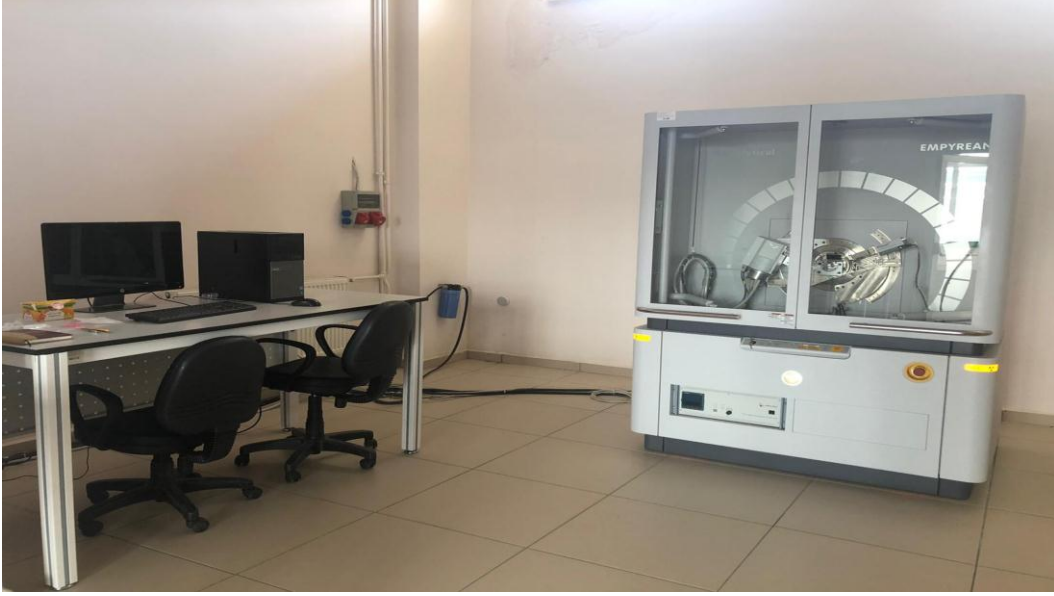
Şekil 2.8. X Işını Difraktometre Cihazı (XRD)
