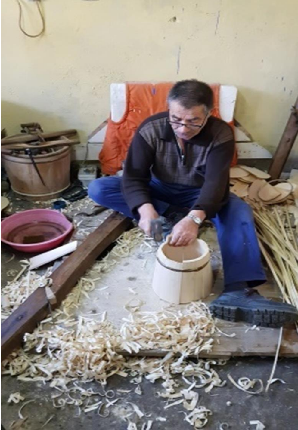
Şekil 3. 63. Yan Yana Dizilen Tahtaları Birleştirme İşlemi Yabani Fındık Dalından Elde Edilen Kuşaklarla Gerçekleştirilmektedir
