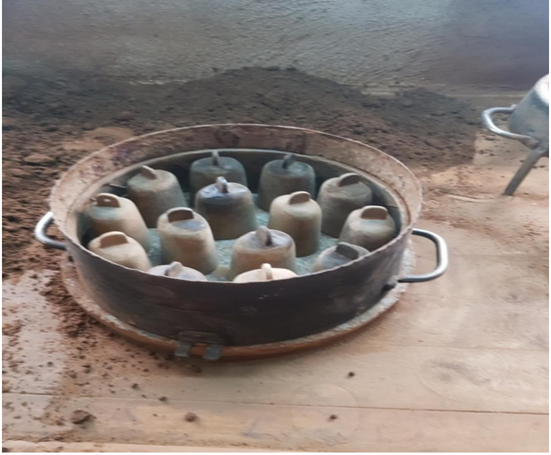
Şekil 3.71. Çan Üretiminde Kullanılan Dişi Kalıplar
