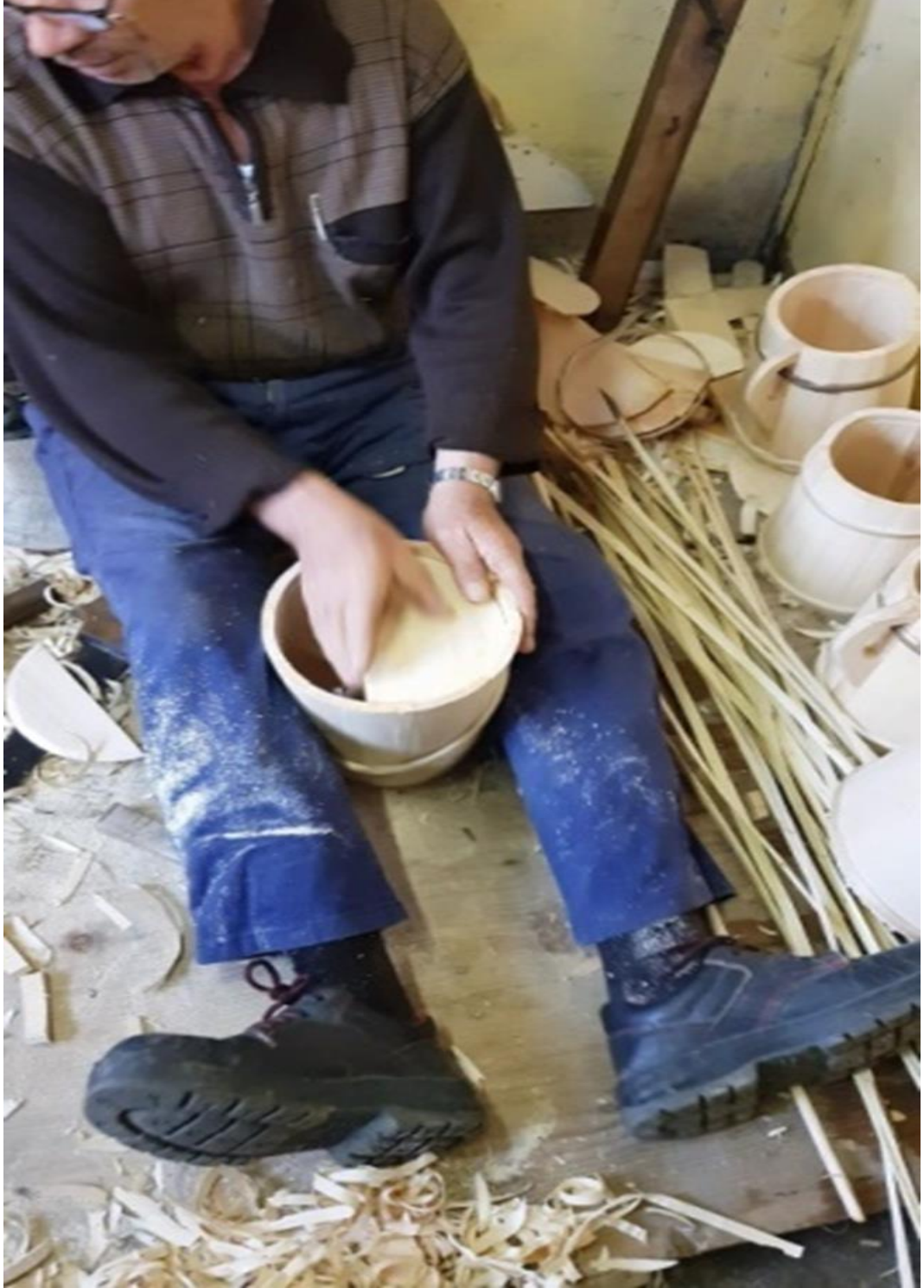
Şekil 3. 64. Ahşap Kabin Tabanlılık Kısımının Monte Edilmesi
