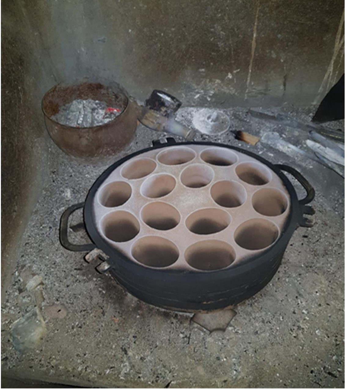
Şekil 3.70. Çan Üretiminde Kullanılan Erkek Kalıplar
