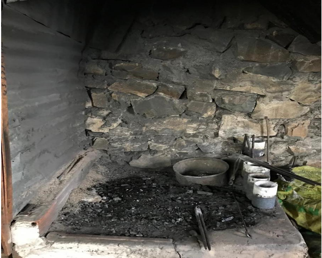
Őekil 3.74. Kantar İmalinde Pirincin EritildiĐi Ocak
