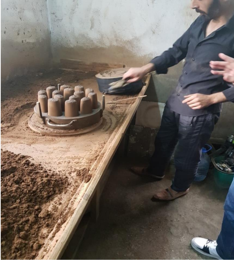
Şekil 3.73. Çan Üretiminde Sıcak Alaşımın Kalıba Dökülme Aşaması
