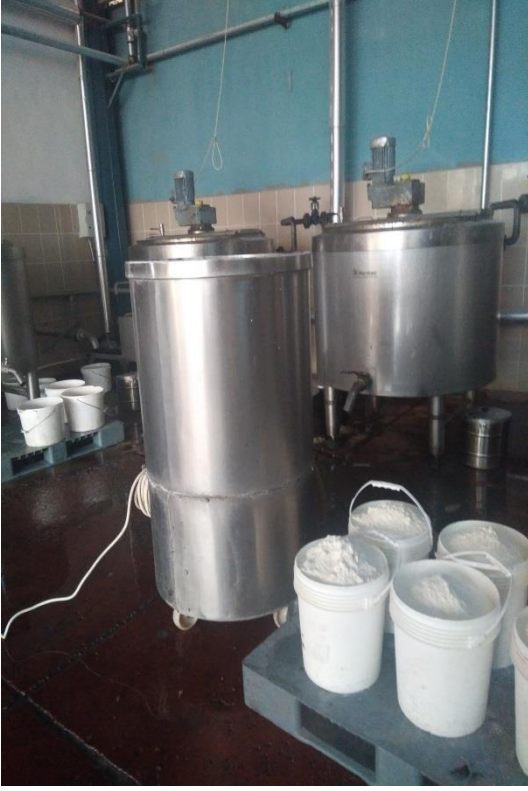
Şekil 2.2. Çırpma mikseri
