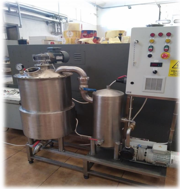
Şekil 2.5. Yağ ısıtılmalı kazan
