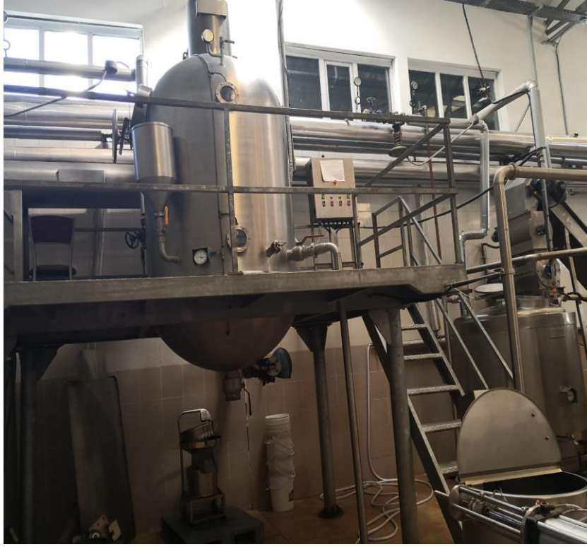
Şekil 2.1. Vakum evaporatörü
