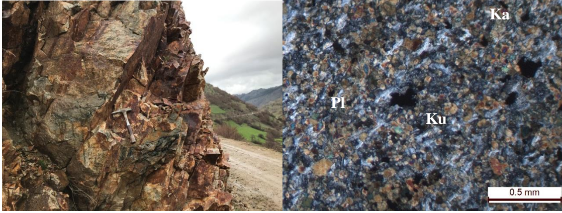
Şekil 3.7. Açık sarı, bej renkte ve belirgin tabakalanma gösteren kumlu kireçtaşı b) Kermutdere Formasyonu içindeki kumlu kireçtaşlarına ait kuvars ve plajiyoklas mineralleri (Ç.N. Pl: Plajiyoklas, Ku: Kuvars, F: Feldspat, Ka: Kalsit)
