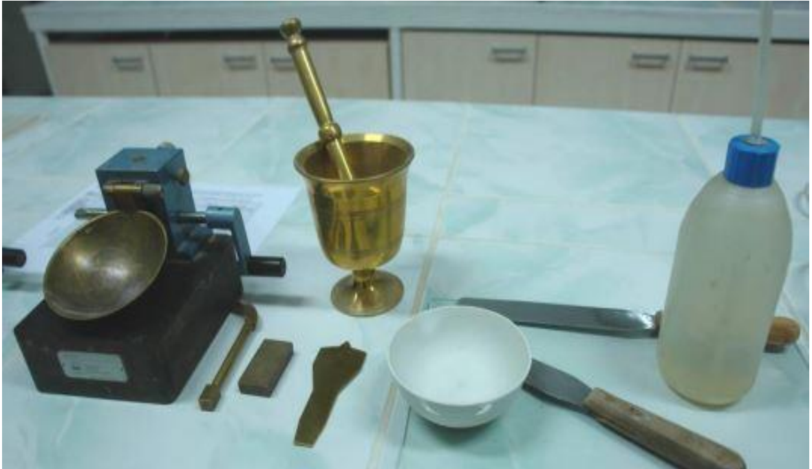
Şekil 2.10. Likit limit deney seti (URL-11).
