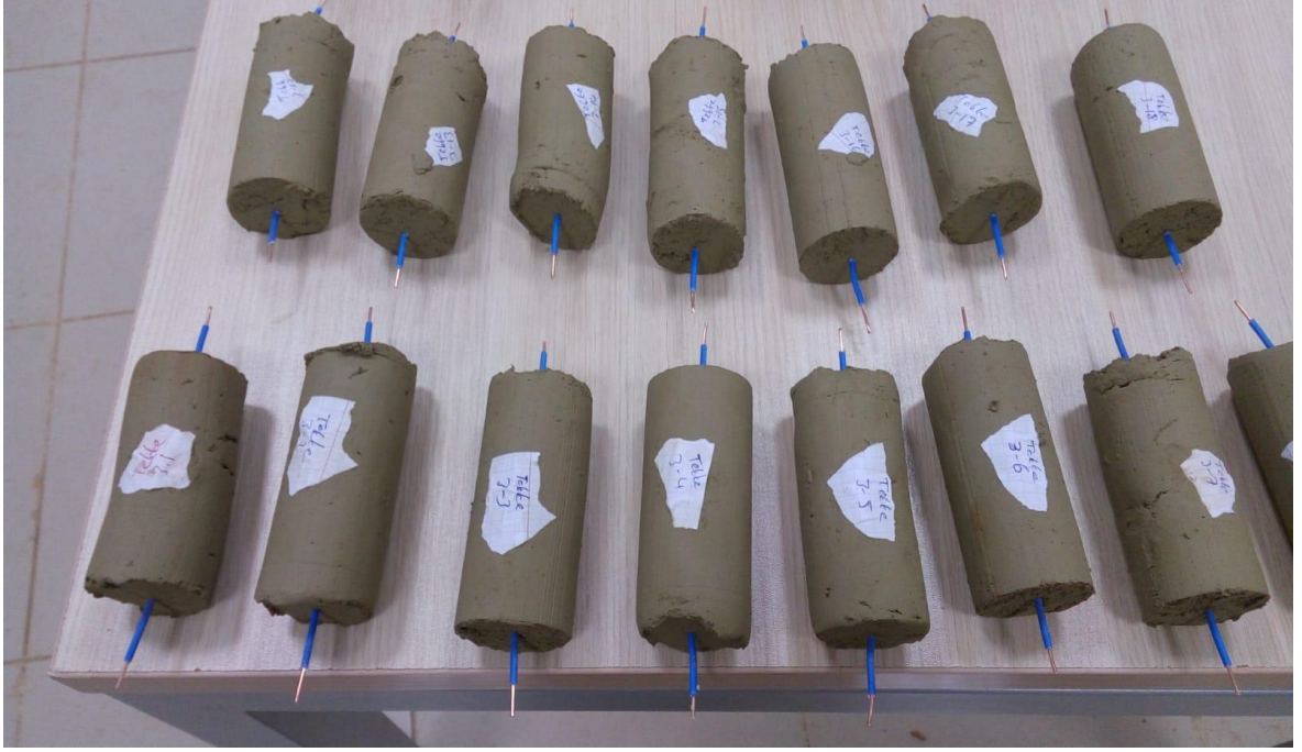
Şekil 2.19. Kalıptan çıkarılmış Tekke bölgesi numuneleri
