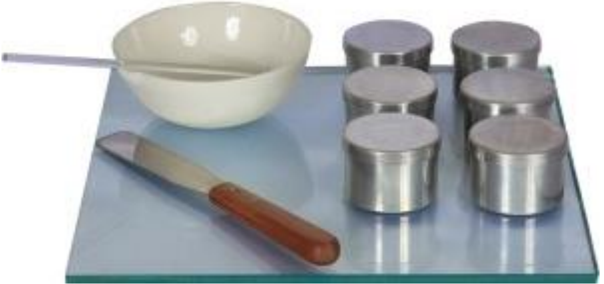
Şekil 2.9. Plastik limit deney seti (URL-10).
