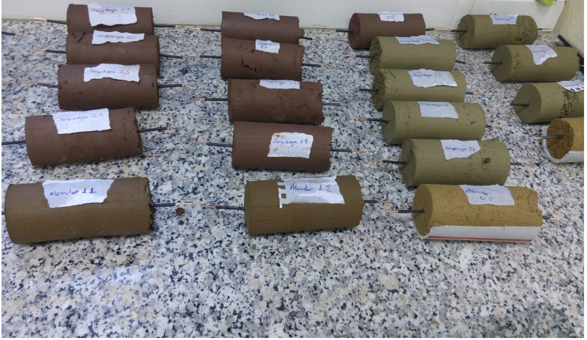
Şekil 2.17. Kalıptan çıkarılmış Alemdar- Sarginkaya bölgelerinin numuneleri
