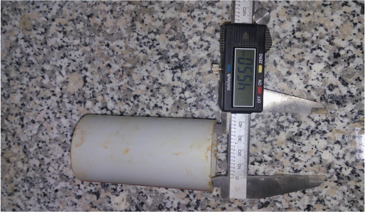
Şekil 2.13. Numune kalıbının çapının kumpas ile ölçümü
