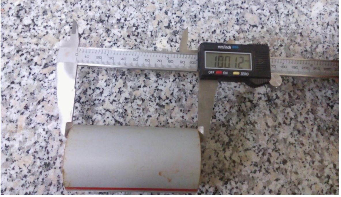
Şekil. 2.12. Numune boyunun kumpas yardımıyla ölçümü
