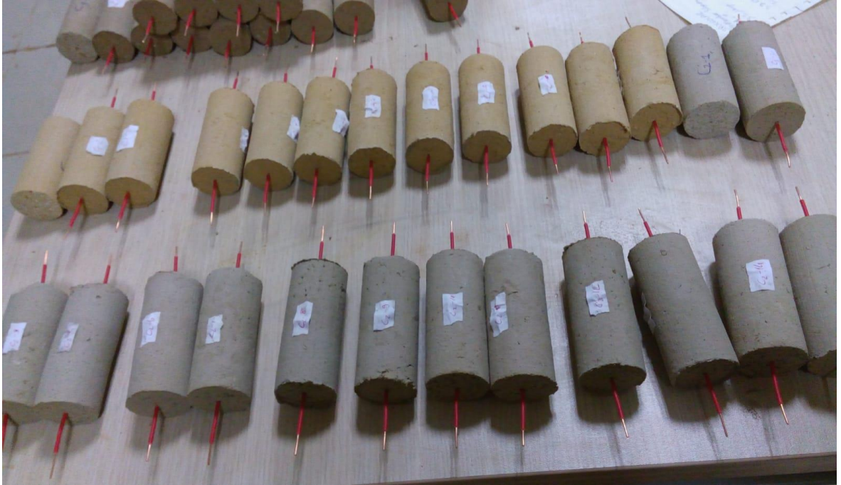
Şekil 2.18. Kalıptan çıkarılmış Canca bölgesi numuneleri
