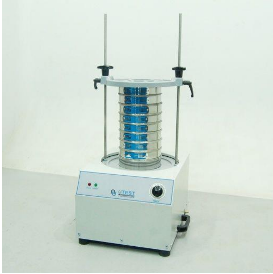
Şekil 2.8. Elek takımı ve sarsma tablası (URL-9).
