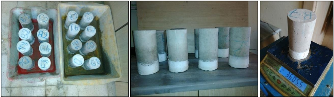
Şekil 2.5. Kapilarite deney düzeneği
