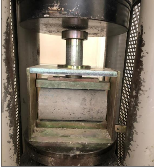
Şekil 2.4. Yarmada çekme deney düzeneği
