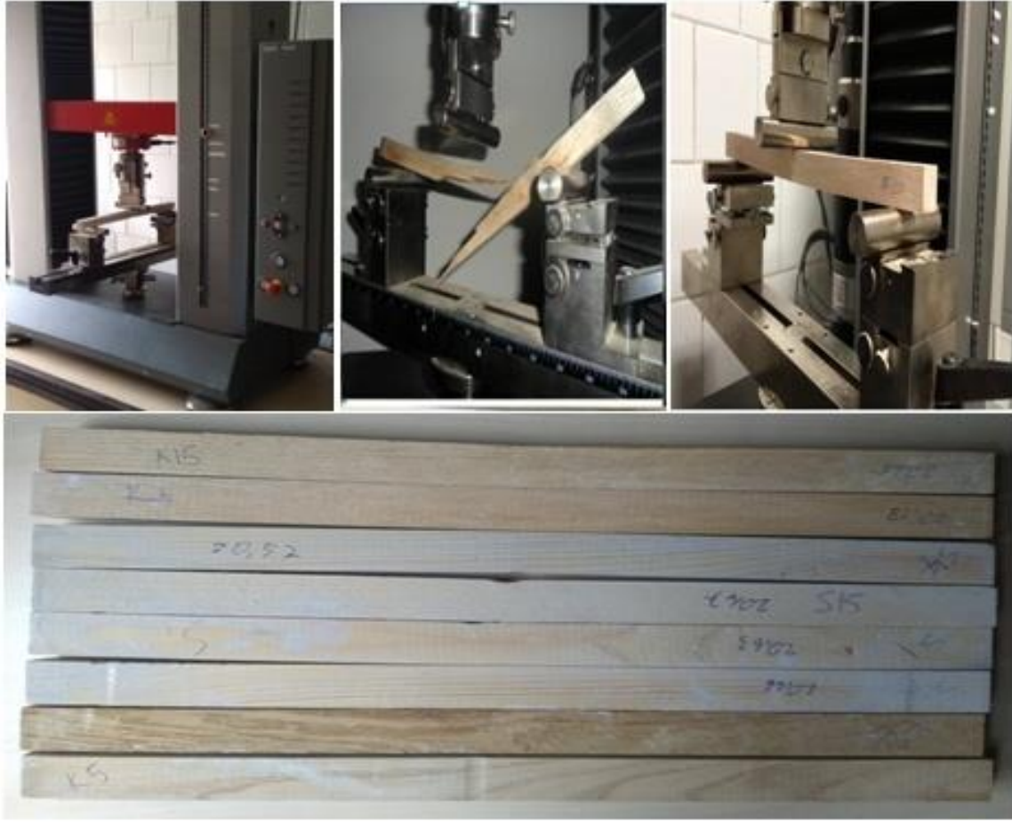
Şekil 2.8. Eğilme direnci ve esneklik modülü deney örneklerinin test edilme anları
