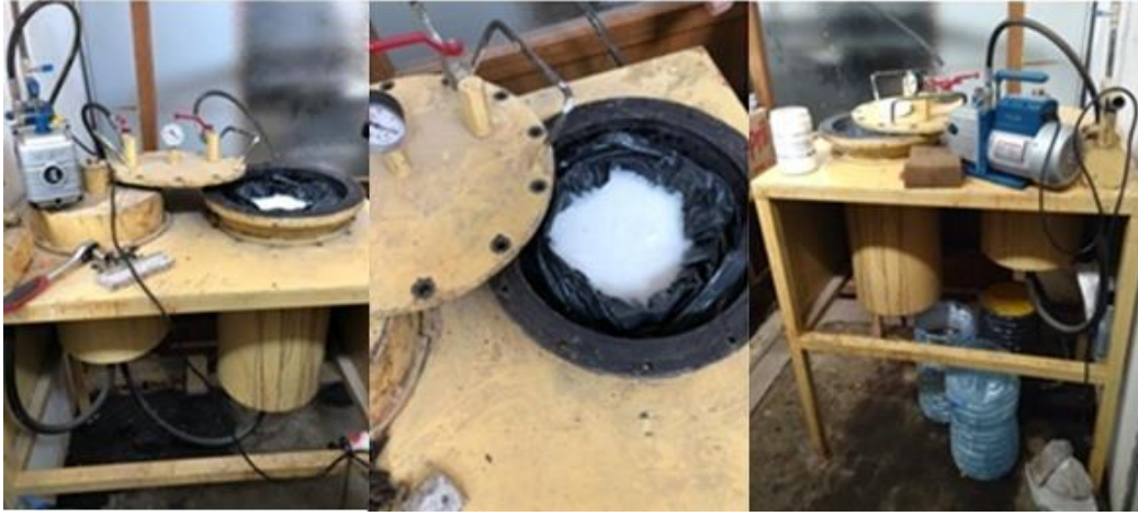
Şekil 2.3. Emrenye kazanının deney esnasındaki görünümü
