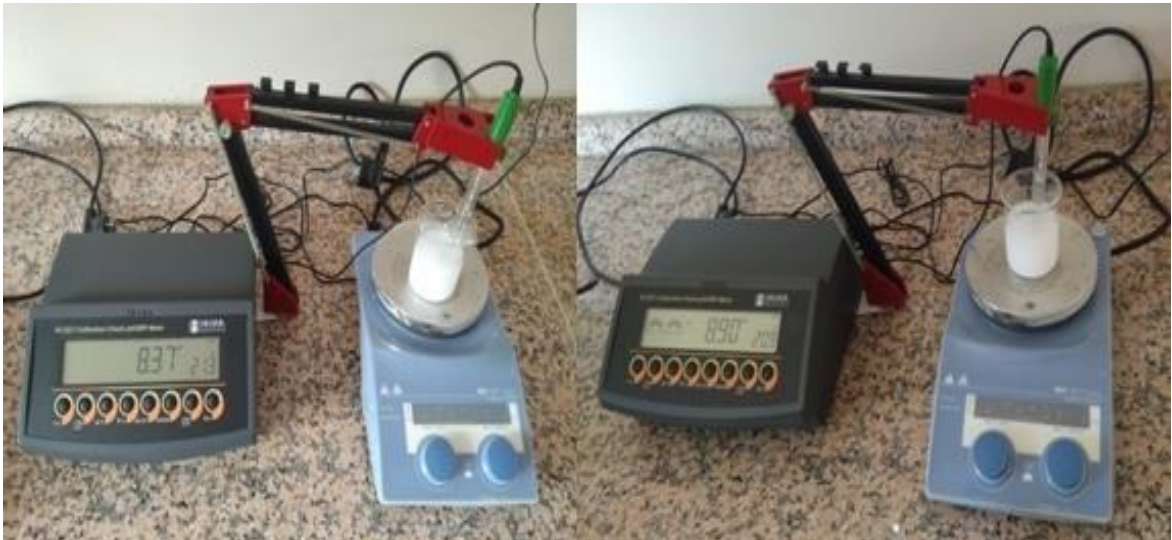
Şekil 2.4. Hegzagonal bor nitrür'ün pH metre ölçümü
