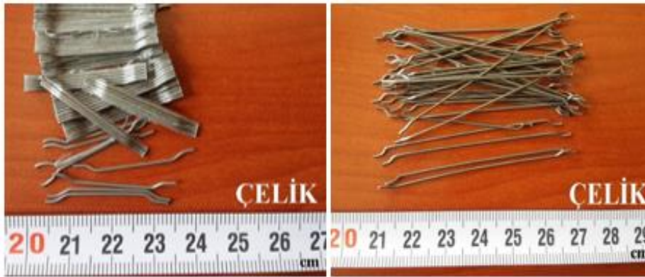
Şekil 2.3. Betonda kullanılan kısa ve uzun çelik lifler
