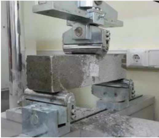
Şekil 2.7. Eğilme basınç deneyi
