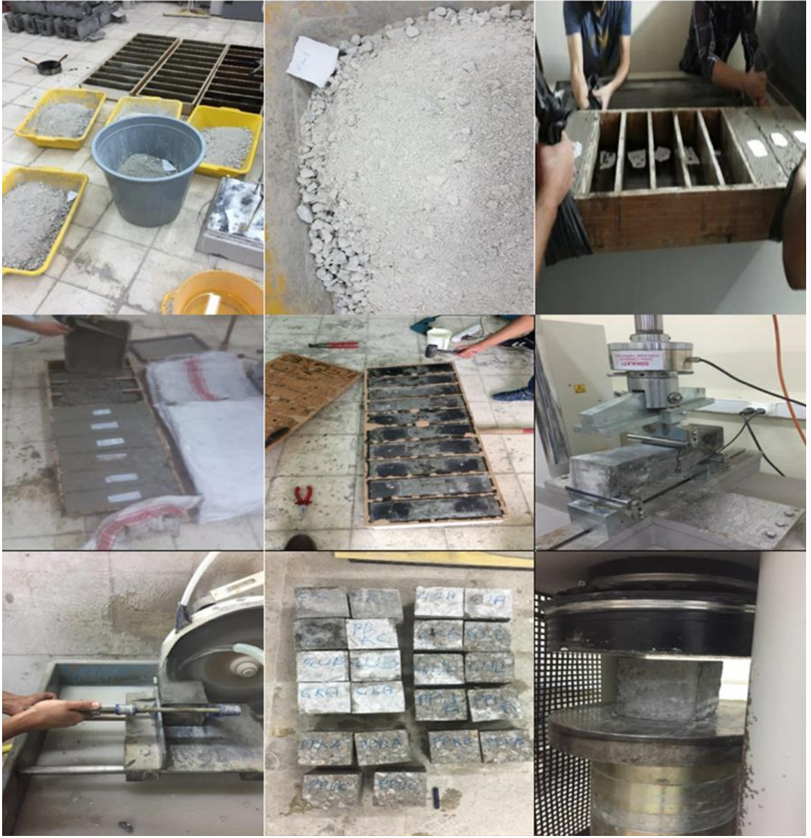
Şekil 2.5. Lifli beton yapım aşamaları
