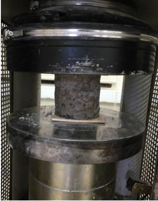
Şekil 2.6. Beton basınç deneyi
