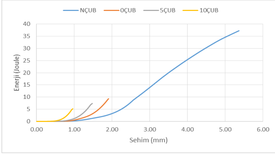
Şekil 3.71. B oranlı uzun çelik takviyeli beton örneklerin maruz kaldığı sıcaklığa bağlı Enerji-Sehim grafikleri
